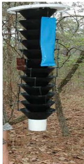
Figura 22: Armadilha múltipla funnel-trap utilizada para monitoramento de Dendroctonus frontalis nos Estados Unidos.
