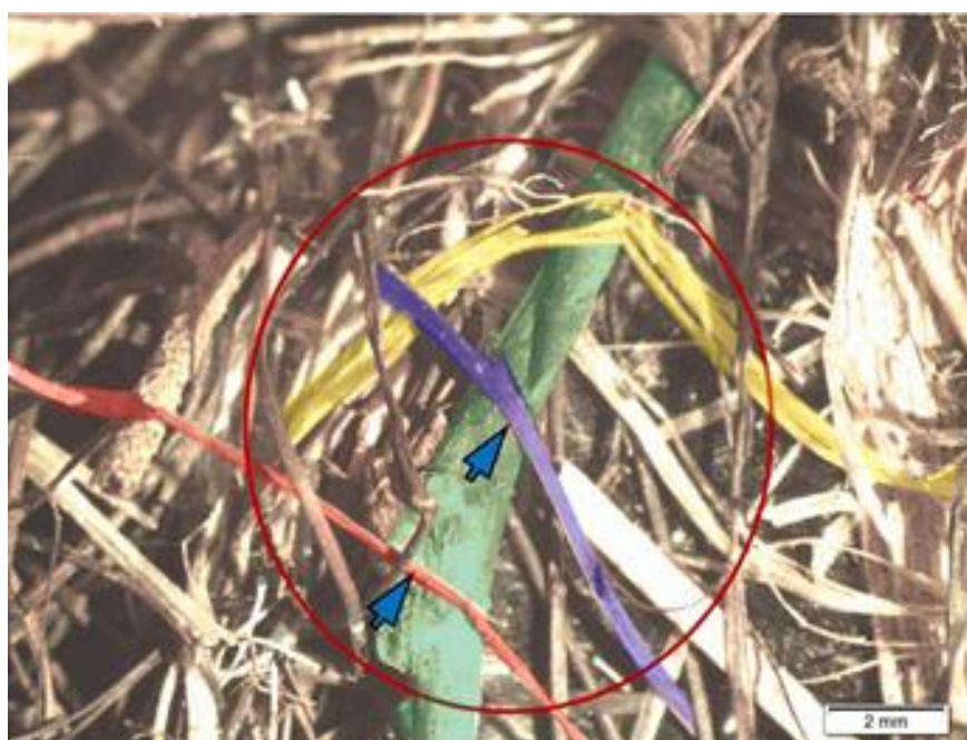
Figura 93 - Ninho 04 ponto 06 - fibras com tensão de puncionamento
