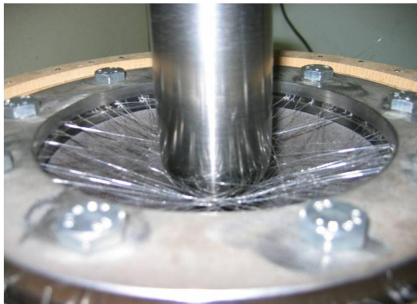
Figura 125 - Teste de puncionamento com pistão hemisférico
