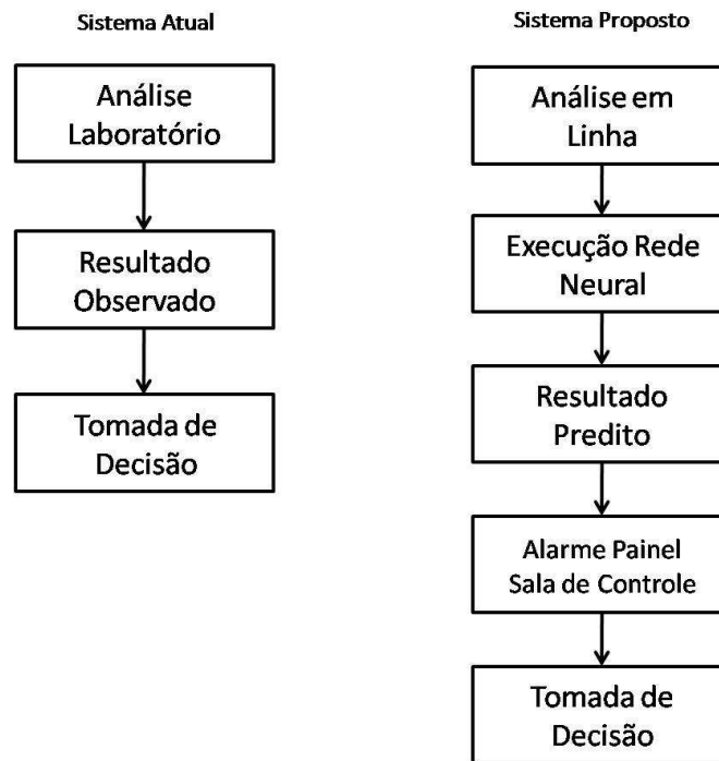
Figura 4.22: Diagrama de blocos com o sistema atual e proposto de monitoramento da unidade de tratamento de efluentes.
