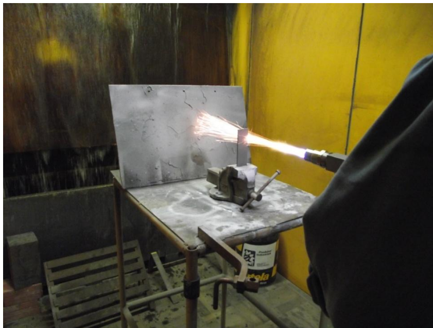
Figura 44. Processo de deposição das amostras B, C e D
