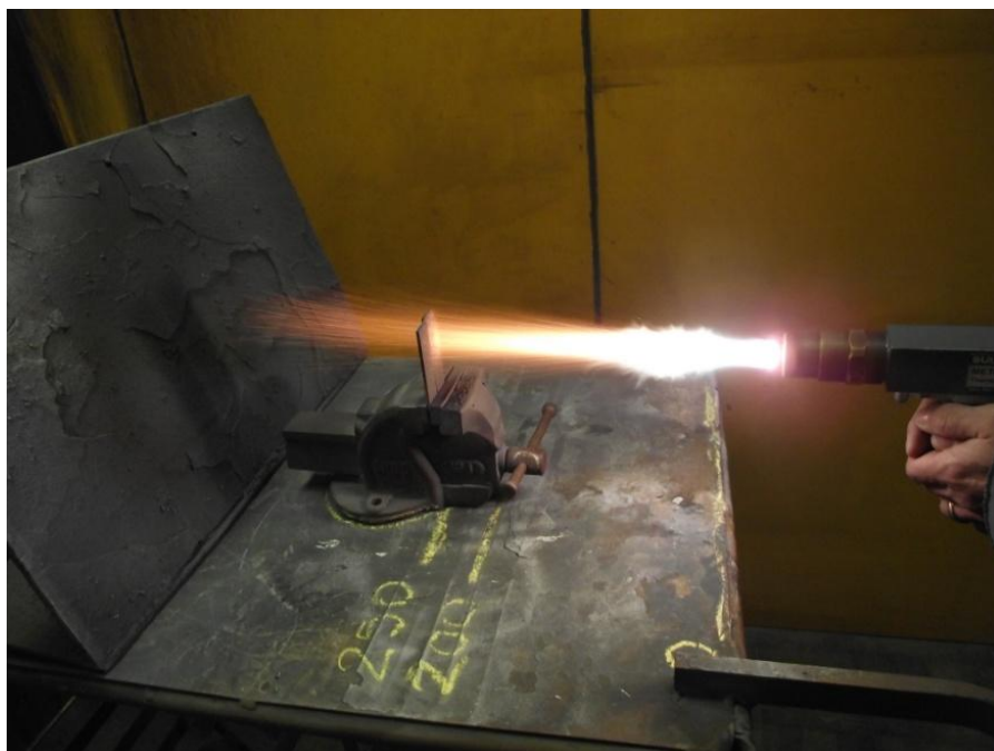
Figura 15. Posicionamento da pistola de aspersão durante a deposição sobre o substrato.
