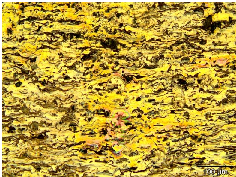
Figura 47. Característica geral do revestimento B2 (ampliação 200x)
