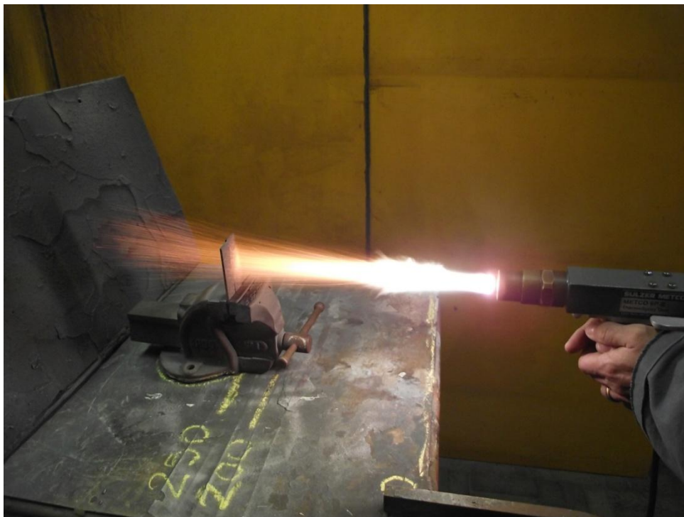
Figura 28. Deposição da liga 95Ni5Al ( Diamalloy ).
