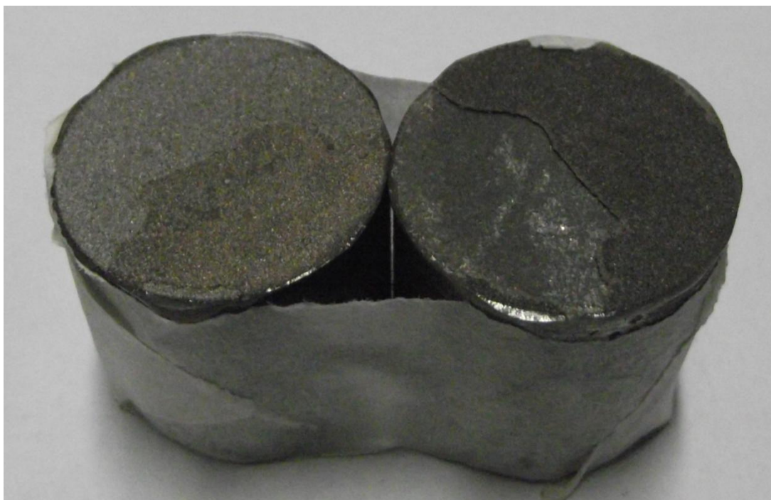
Figura 26. Corpo de prova número 15 evidenciando a ruptura
