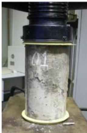
FIGURA 13. ENSAIO PARA DETERMINAÇÃO DA RESISTÊNCIA À COMPRESSÃO NOS CORPOS DE PROVA.
