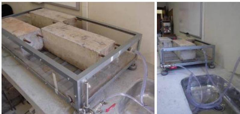
FIGURA 18. ENSAIO DE ABSORÇÃO DE ÁGUA POR SUCÇÃO CAPILAR DE ACORDO COM A NBR 9779:1995.
