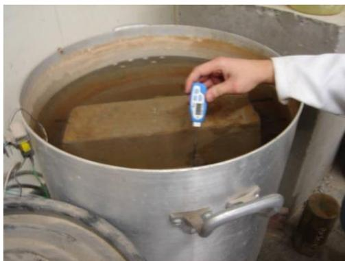
FIGURA 17. ENSAIO DE ANÁLISE DE POTENCIAL DE CORROSÃO SOB SEGUNDO GRADIENTE DE TEMPERATURA.
