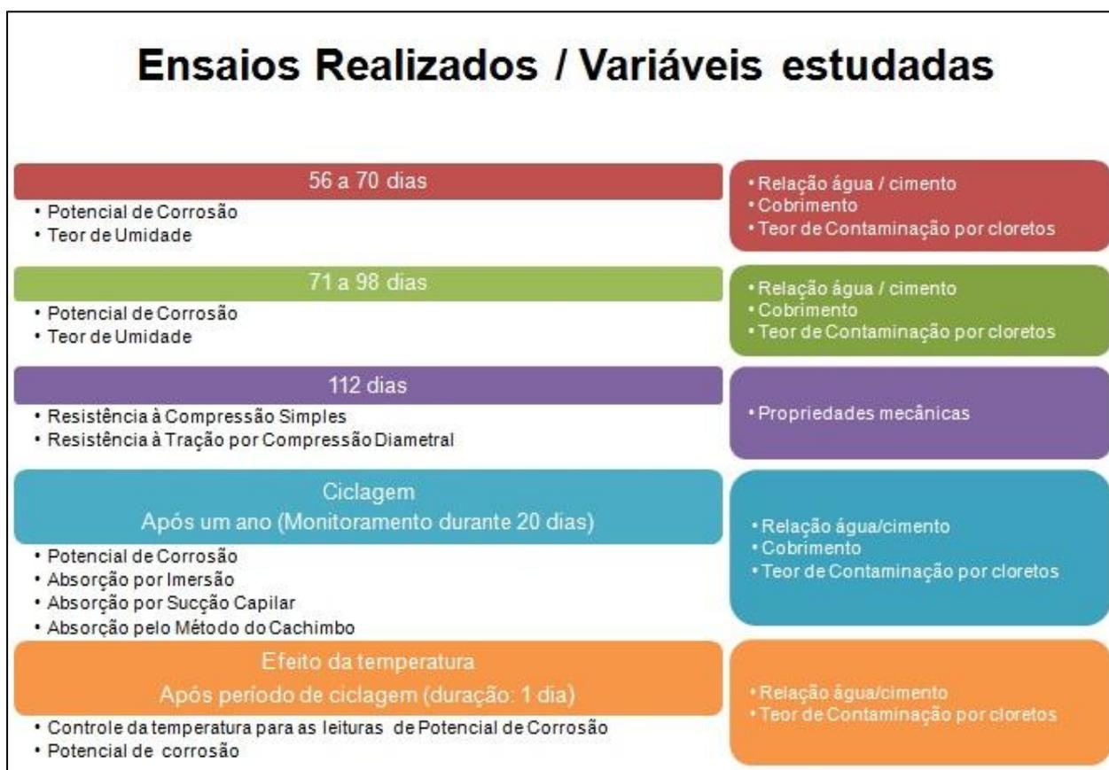
FIGURA 16. REPRESENTAÇÃO ESQUEMÁTICA DOS ENSAIOS REALIZADOS EM CADA ETAPA DO MONITORAMENTO E AS VARIÁVEIS DE RESPOSTA ANALISADAS.
