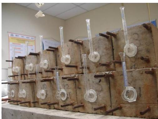
FIGURA 19. FIXAÇÃO DO CACHIMBO NA FACE DE ARMADURA EXPOSTA.
