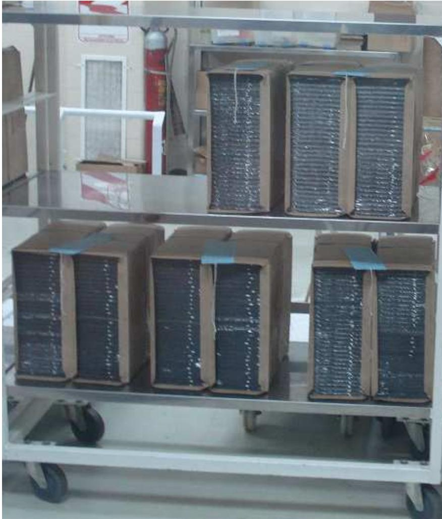
FIGURA 2.3 – PARTE ATIVA DO CAPACITOR FINALIZADA
