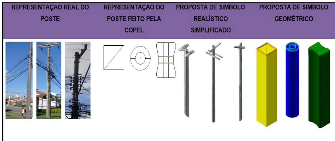
FIGURA 69 – QUADRO RESUMO DA FEIÇÃO REAL, A REPRESENTAÇÃO BIDIMENSIONAL E AS DUAS PROPOSTAS DE SIMBOLOGIA FONTE: A AUTORA, 2011
