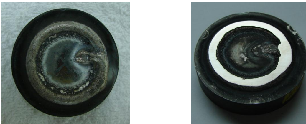
Figura 3.10 – (a) Aspecto do cordão circular (120 A) como depositado. (b) Aspecto do cordão circular (120 A) após preparação da superfície para ensaios de desgaste.
