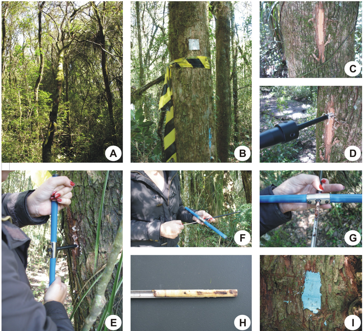
FIGURA 2. Etapas da coleta de amostras não destrutivas de madeira. A – Guettarda uruguensis em solo contaminado. B - Identificação com plaqueta numérica dos indivíduos. C – Preparo superficial e remoção da casca com uso de formão. D, E – Coleta com uso de trado de incremento. F, G, H – Retirada da amostra do trado. I – Detalhe do tratamento preventivo da lesão.
