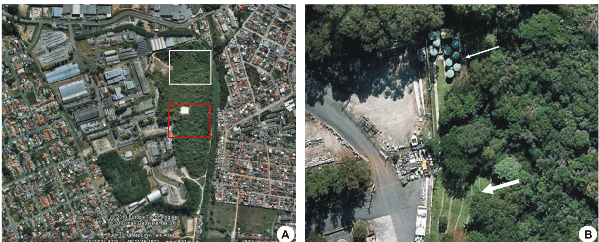
FIGURA 1. A - Vista aérea da área da COPEL, Atuba, Curitiba, PR, na área contaminada com óleo mineral isolante (retângulo vermelho) e área não contaminada (retângulo branco). B - Sistema cíclico de tratamento para biorremediação. Tanques de coleta e tratamento por bactérias (seta estreita). Trincheiras drenantes (seta larga).
