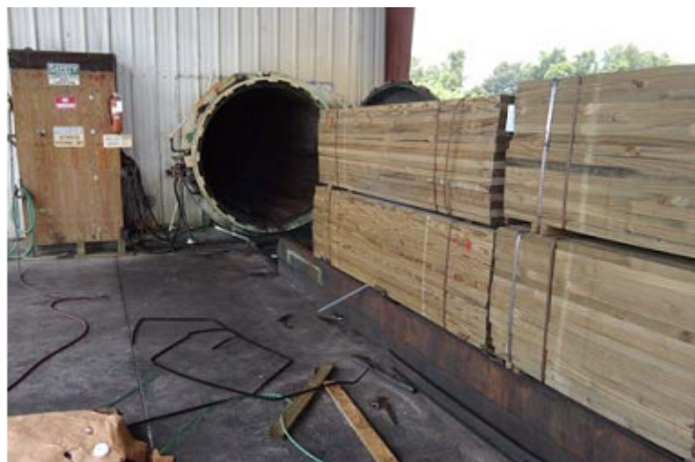
FIGURA 9 - TRATAMENTO DE MADEIRA EM AUTOCLAVE
