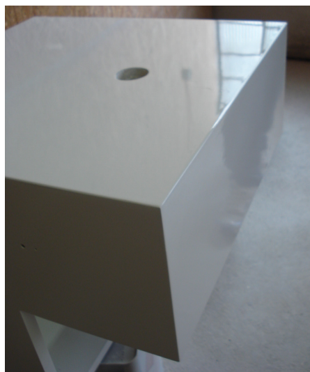
FIGURA 12 - MÓVEL LAQUEADO (LACA DE ALTO BRILHO À BASE DE RESINA NITROCELULÓSICA)
