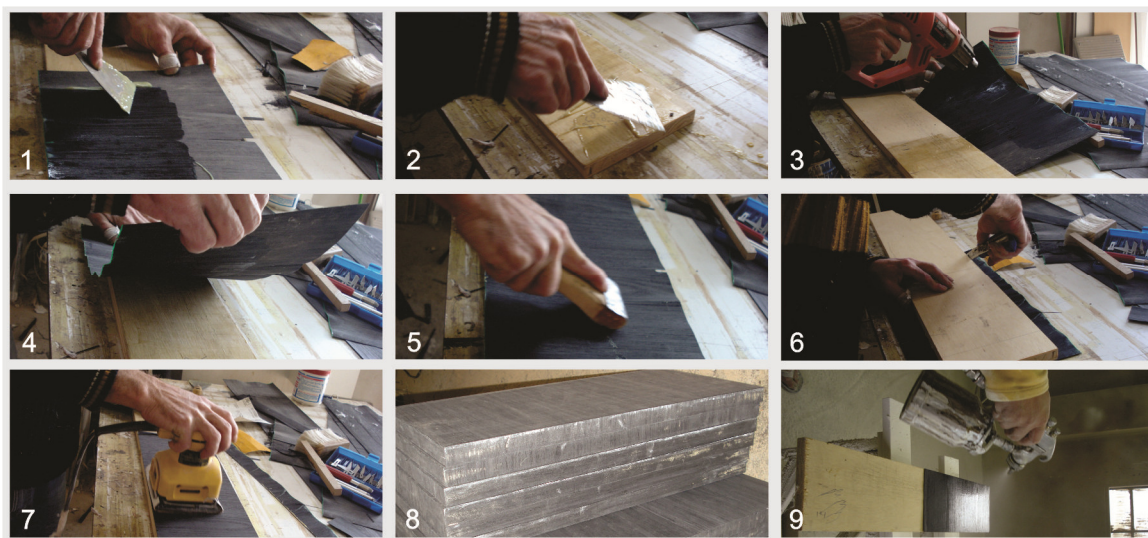
FIGURA 14 - PROCESSO DE LAMINAÇÃO DE PAINÉIS DE MDF
