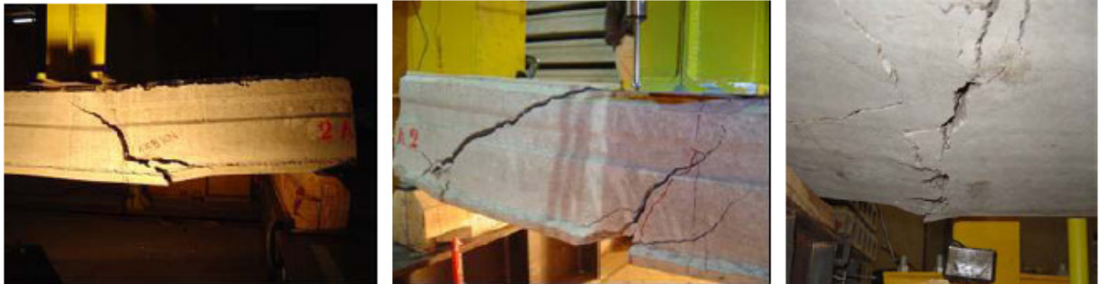
FIGURA 19 – PANORAMA FISSURADO DE UMA LAJE ALVEOLAR APÓS ENSAIO DE CISALHAMENTO. FONTE: COSTA (2009).
