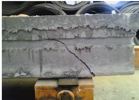
FIGURA 37 – APOIO DA LA001-B PARA O TERCEIRO ENSAIO. FONTE: A autora (2012).
