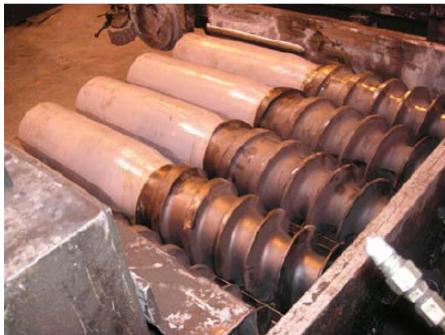
FIGURA 9 - DETALHE DAS HÉLICES DA MÁQUINA EXTRUSORA. FONTE: EDEKLING et al. (2006) apud COSTA (2009).
