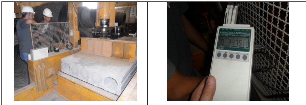
FIGURA 30 – APLICAÇÃO E LEITURA DA CARGA DURANTE UM ENSAIO. FONTE: A autora (2012).
