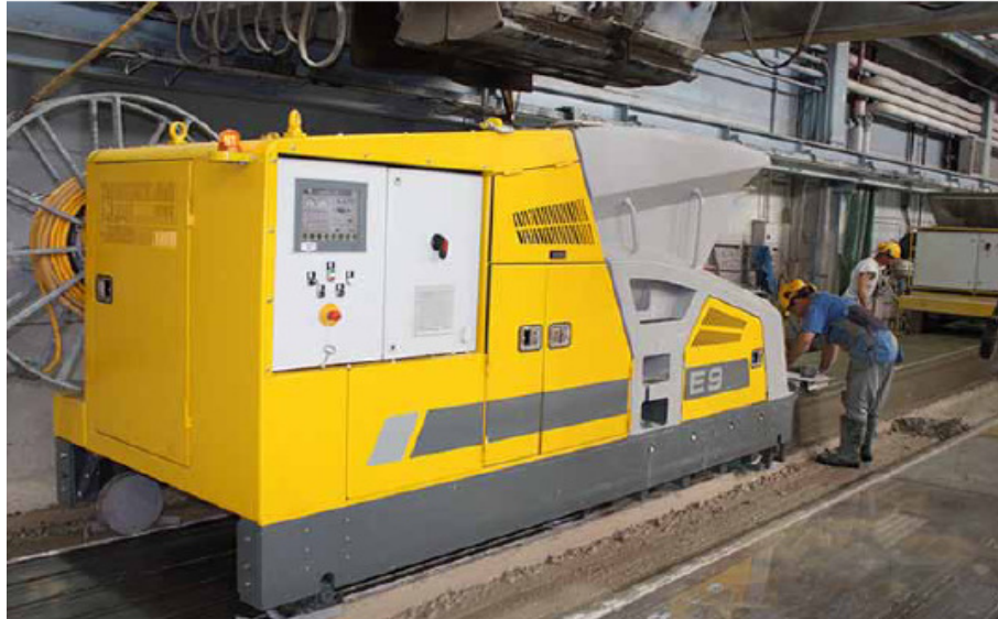
FIGURA 8 - MÁQUINA EXTRUSORA PARA FABRICAÇÃO DE LAJES ALVEOLARES. FONTE: Disponível em http://www.precastfountain.com/precast_machinery/extruder-1 . Acesso em: 18 jun 2011.
