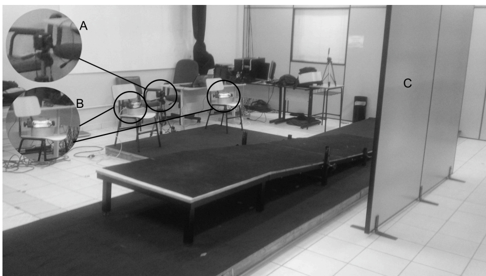
FIGURA 4.2 – AREA DE COLETA UTILIZADA NO PRESENTE ESTUDO. A) CÂMERA, B) HOLOFOTES E C) CALIBRADOR (VISTO POSTERIORMENTE).
