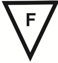
Figura 39 - Símbolo que indica a proteção ao material da superfície de apoio FONTE: NBR 5410
