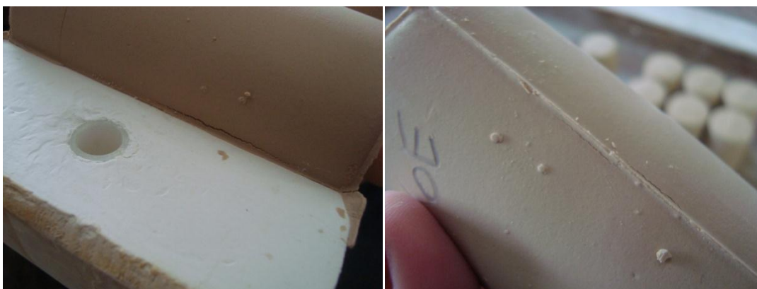
Figura 55 - Rachaduras no produto após o desmolde FONTE: A autora (2011)
