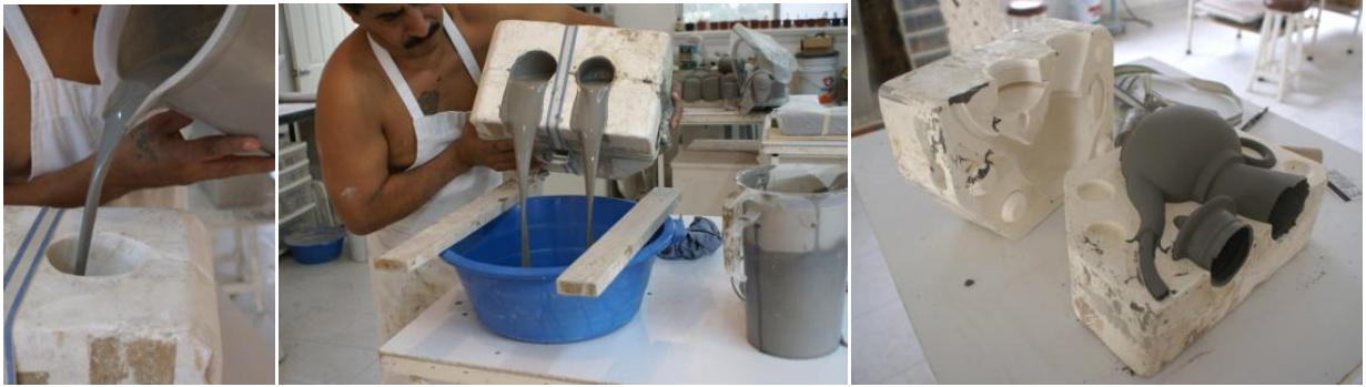
Figura 17 - Etapas de conformação por colagem de barbotina FONTE: www.ceramicatrespiedras.com (2010)
