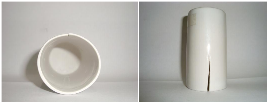
Figura 54 - Amostras com borda deformada e com rachadura FONTE: A autora (2011)
