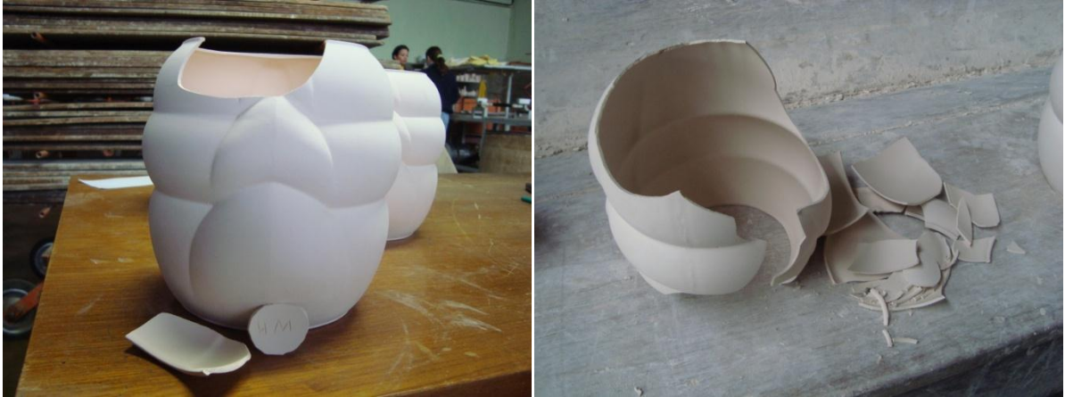
Figura 78 – 04 minutos: quebra após o biscoito e 05 minutos: quebra durante a secagem FONTE: A autora (2012)
