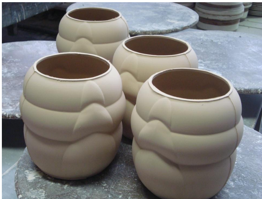
Figura 79 – peças cruas produzidas com 10 minutos de envase da barbotina FONTE: A autora (2012)
