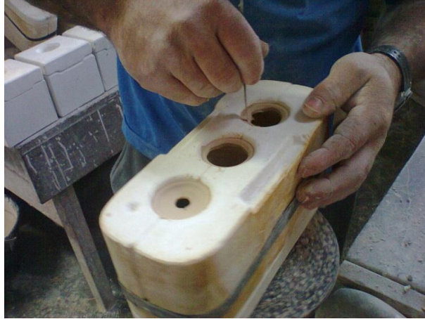
Figura 53 - Fundo do saleiro sendo retirado FONTE: A autora (2011)
