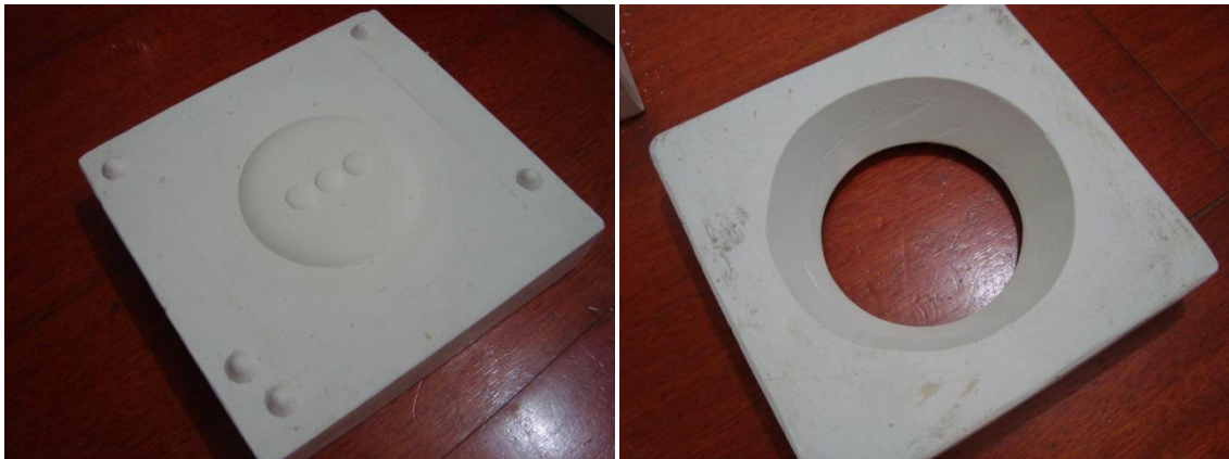
Figura 76 – Extremidades do molde para construção da base e boca de enchimento da luminária FONTE: A autora (2012)
