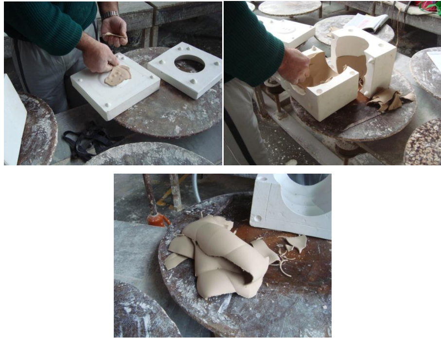
Figura 77 – Peças com problemas de desmoldagem FONTE: A autora (2012)
