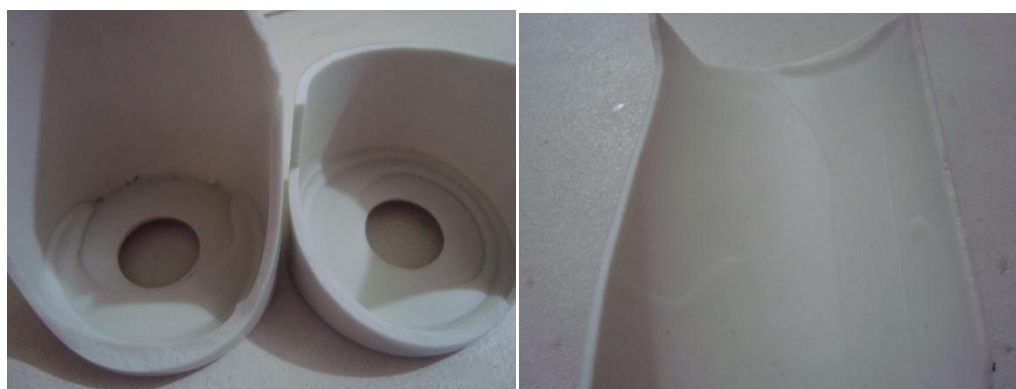
Figura 58 - Imagem da base com acúmulo de massa e da parede com as marcas do processo de verter o excedente da barbotina FONTE: A autora (2012)
