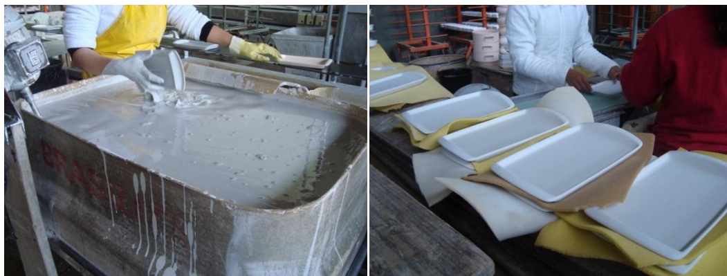
Figura 46 - Produto sendo submergido no vidrado e com o vidrado aplicado FONTE: A autora (2011)
