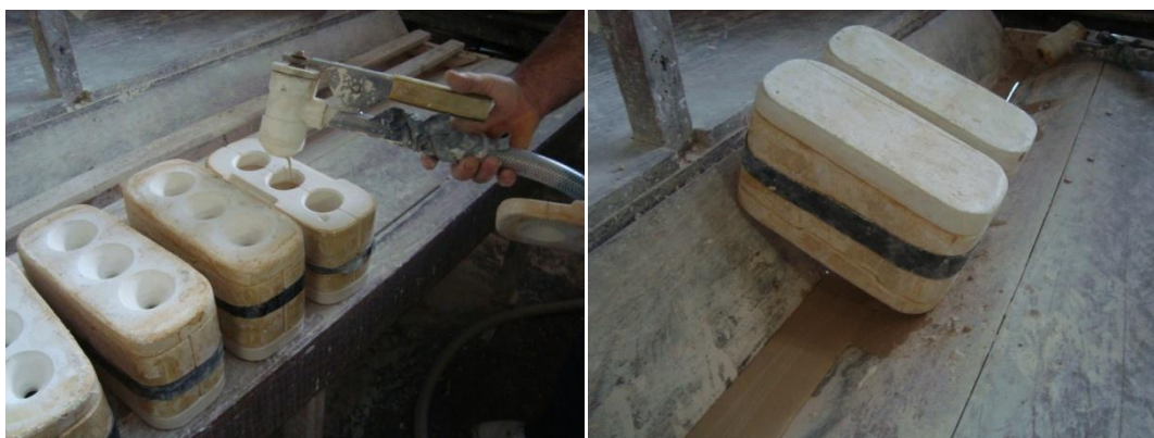
Figura 52 - Moldes sendo preenchidos com a barbonita e a barbotina sendo vazada FONTE: A autora (2011)
