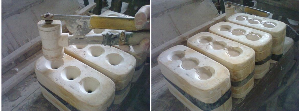
Figura 44 - Barbotina sendo vertida no molde e em descanso para formação do produto FONTE: A autora (2011)
