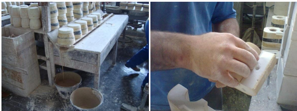
Figura 45 - Barbotina sendo vazada e o produto sendo desmoldado FONTE: A autora (2011)
