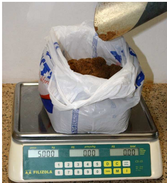
Figura 99: Pesagem individual dos sacos de areia
