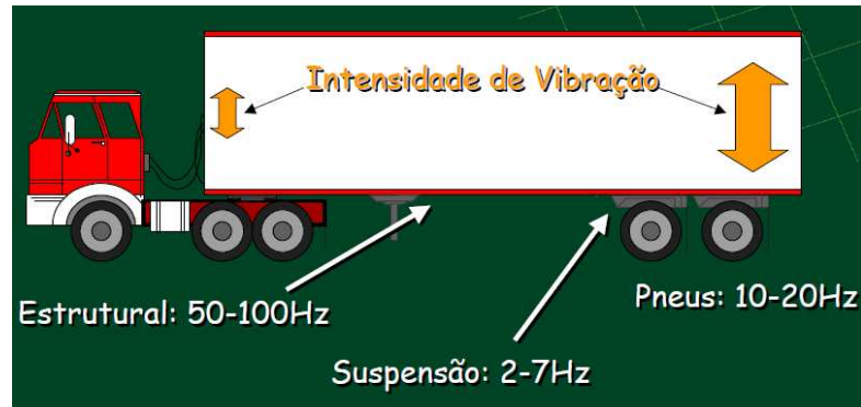
Figura 49: Esquema das frequências no transporte rodoviário Fonte: Bordin (2007)
