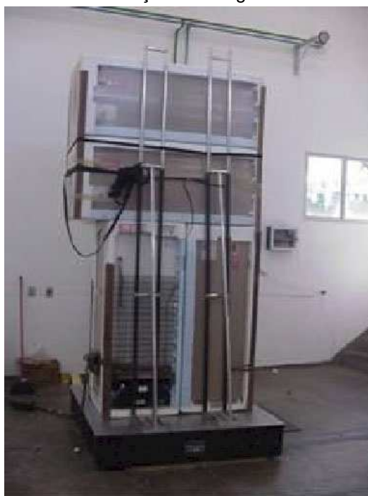
Figura 2: Ensaio de vibração com empilhamento
