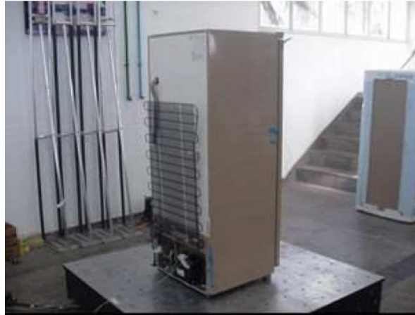
Figura 71: Mesa vibratória executando ensaio em refrigerador Fonte: CETEA/JICA (2005)
