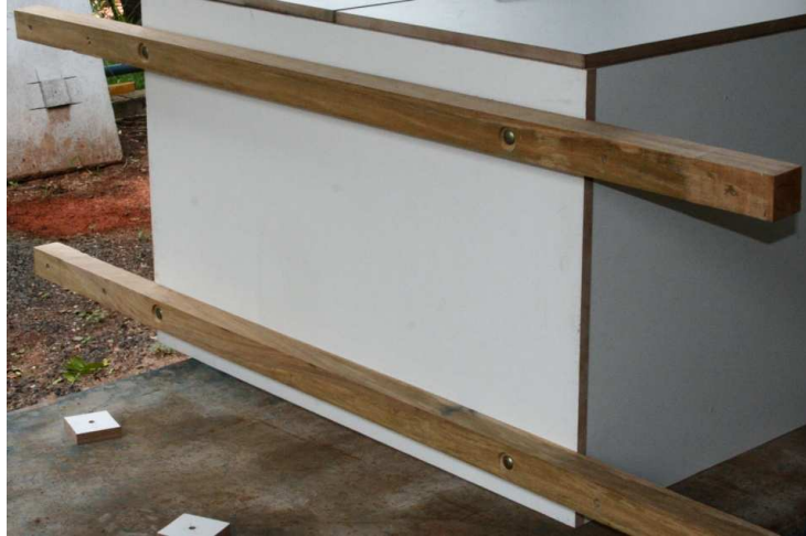
Figura 95: Fixação dos caibros sob os corpos de prova
