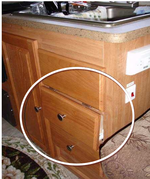
Figura 27: Gaveta de um motorhome danificada pela vibração. Fonte: 2manytoyz (2010)
