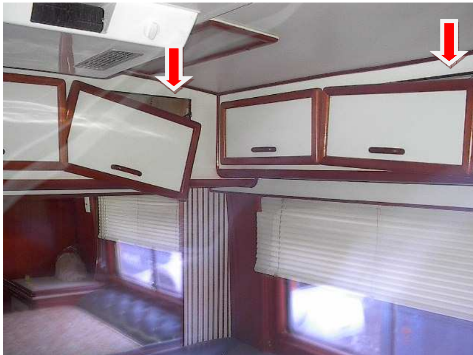
Figura 60: Portas danificadas e desalinhadas Fonte: Matheus (2011)
