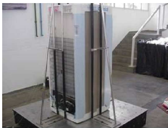
Figura 3: Ensaio de vibração com embalagem
