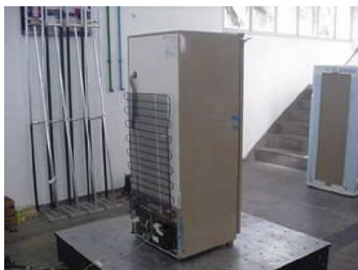
Figura 1: Ensaio de vibração de refrigerador sem embalagem
