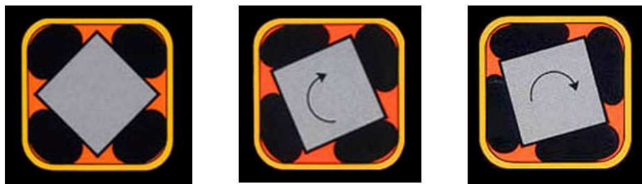
Figura 55: Funcionamento de Suspensão Elastomérica Fonte: GKN (2010)
