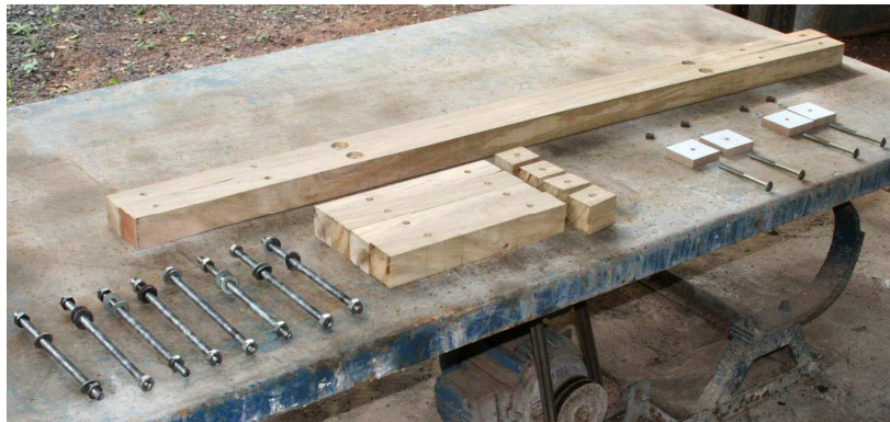
Figura 94: Peças usadas para fixação dos corpos de prova
