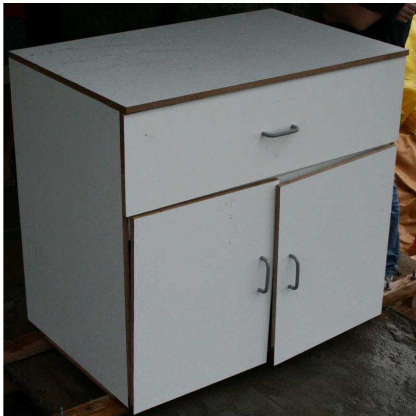
Figura 104: Ambas portas desalinhas (CP1)
