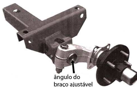
Figura 57: Braço ajustaveel em suspensão elastomérica Fonte: Adaptado de Dexter (2010)
