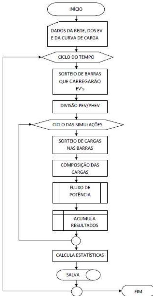
Fig. 3.6 – fluxograma do motor de simulação.
