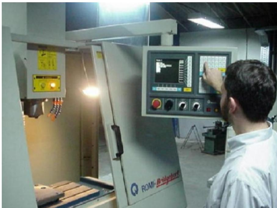
Figura 3.1: Painel de Comando da Máquina-ferramenta ROMI Discovery 4022. Fonte [30].
