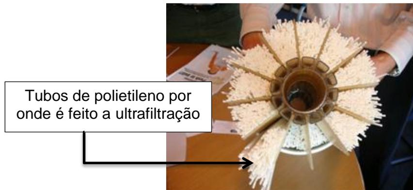
FIGURA 10 – FOTO INTERNA DE UM CARTUCHO DE MEMBRANA
