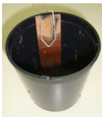
Figura 3. Armadilha ovitrampa composta por um vaso preto de 500 ml, uma paleta de eucatex presa com um clipe ao suporte de plástico preto. Foto cedida por Rosinei Kafka (CCZ-Foz do Iguaçu).
