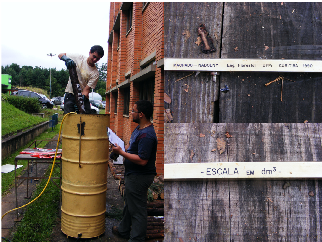
FIGURA 16 - IMERSÃO DA TORA NO XILÔMETRO E ESCALA GRADUADA ( \text{dm}^3 ) FONTE: O Autor (2012)
