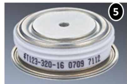
Figura 2.13: À esquerda, a foto do circuito gerador de pulsos 2. A geometria circular e compacta reduz indutâncias e resistências parasitas. À direita, o SCR, que está posicionado entre as placas circulares, cujo contato elétrico é feito por pressão.
