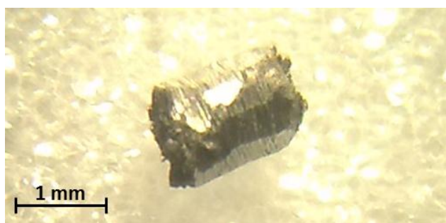
Figura 5.5: Amostra quase cilíndrica de NdFeB (ímã de hd) utilizado para a medição com o circuito gerador de pulsos 3 (unipolar).
