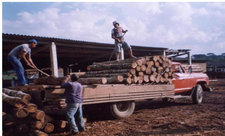
FIGURA 7 - Descarregamento de toras de bracatinga com 2,70 m de comprimento visando serrados e peças de movelaria.
