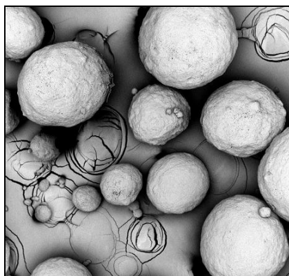
FIGURA 21 - MICROPARTÍCULAS OBTIDAS POR GELIFICAÇÃO INTERNA, AO MEV (180X) FONTE: CENTRO DE MICROSCOPIA ELETRÔNICA UFPR (2011)
