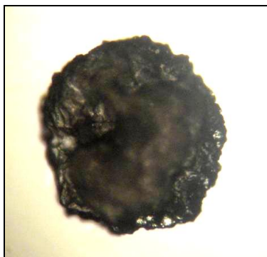
FIGURA 17 - MICROPARTÍCULA COM AMIDO LIOFILIZADA, AO MO (AUMENTO 40X)
