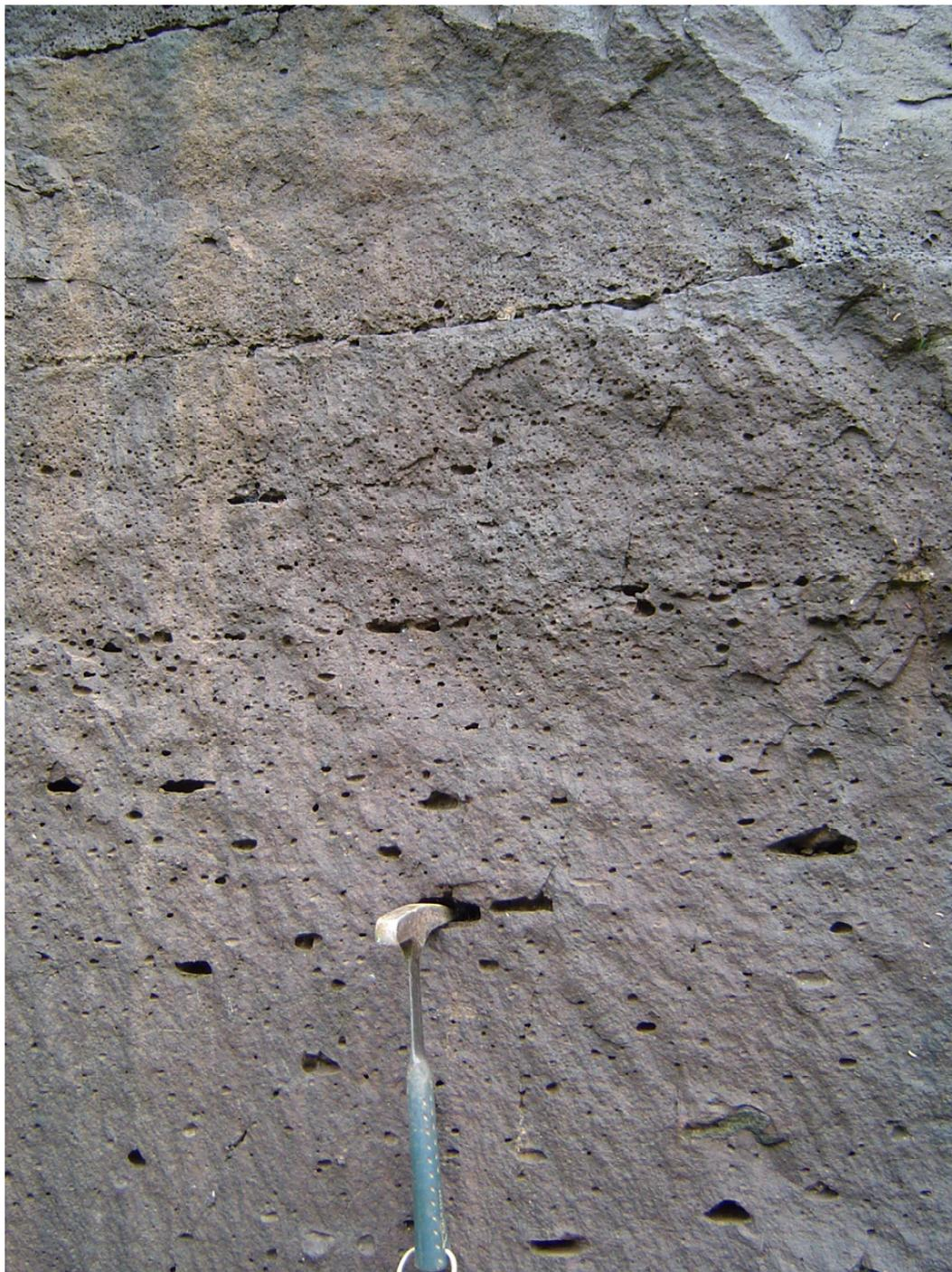
FIGURA 13 - Vesículas aglutinadas nos planos de fluxo ou inflação de derrame tabular de basalto (EA-1209; 316433W; 7221224N; 856 m).
