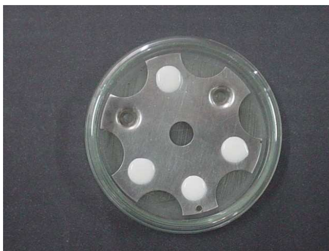
FIGURA 2 – SISTEMA PREPARADO COM O USO DO “TEMPLATE” PARA DETERMINAÇÃO DA ATIVIDADE ANTIMICROBIANA PELO MÉTODO DE DIFUSÃO EM AGAR
