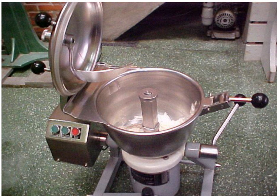
FIGURA 4 – MULTIPROCESSADOR UTILIZADO PARA REFINO DA MASSA DE PATÊ DE FRANGO CREMOSO.
