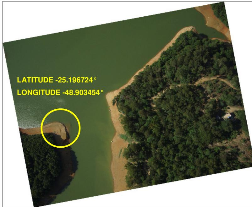
Figura 63: Imagem georreferenciada obtida com o SAMA na área 03, com detalhe erodido na imagem circulado.
