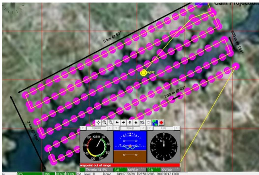
Figura 25: Plano de voo realizado pelo VANT no reservatório Moxotó.
