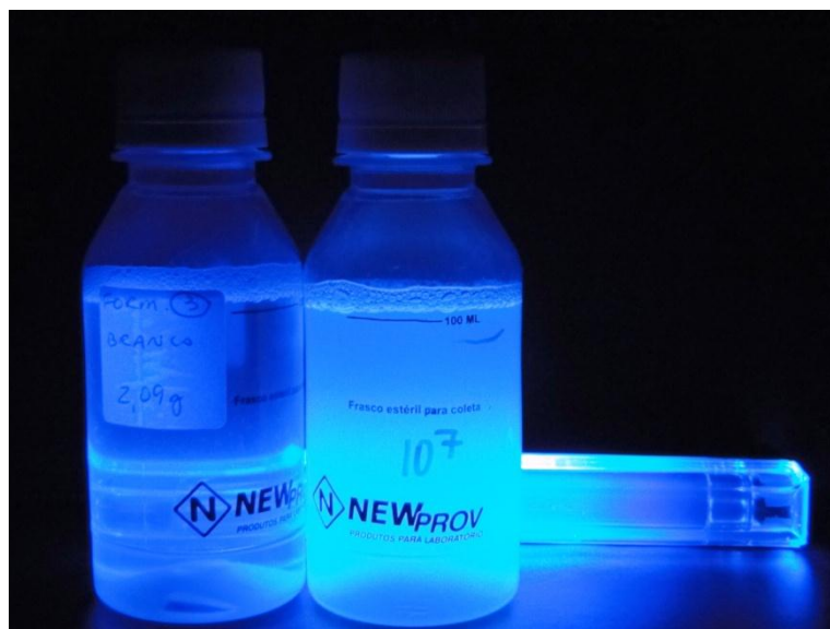
FIGURA 11 - TESTE BRANCO E MEIO DE CULTURA C COM INÓCULO DE 1 \times 10^7 UFC/ML OBSERVADOS SOB LUZ UV DE 254 NM
