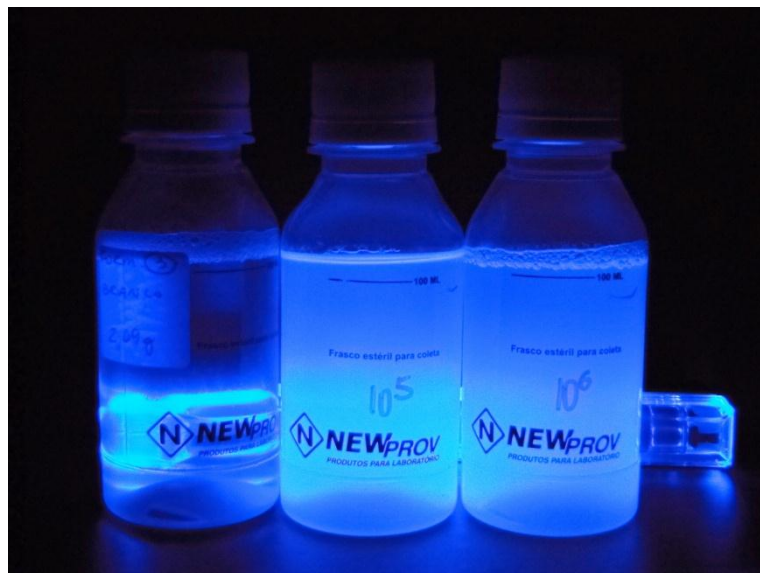
FIGURA 10 - TESTE BRANCO, MEIO DE CULTURA C COM INÓCULO DE 1 \times 10^5 UFC/ML E MEIO DE CULTURA C COM INÓCULO DE 1 \times 10^6 UFC/ML OBSERVADOS SOB LUZ UV DE 254 NM
