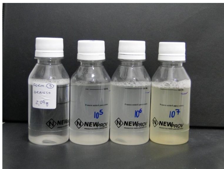
FIGURA 7 - TESTE BRANCO, MEIO DE CULTURA C COM INÓCULOS DE 1 \times 10^5 UFC/ML A 1 \times 10^7 UFC/ML - OBSERVAÇÃO DA TURVAÇÃO SEM INCIDÊNCIA DE LUZ UV FONTE: A AUTORA (2010)
