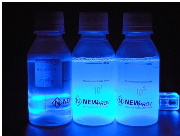
FIGURA 8 - TESTE BRANCO, MEIO DE CULTURA C COM INÓCULO DE 1 \times 10^1 UFC/ML E MEIO DE CULTURA C COM INÓCULO DE 1 \times 10^2 UFC/ML OBSERVADOS SOB LUZ UV DE 254 NM
