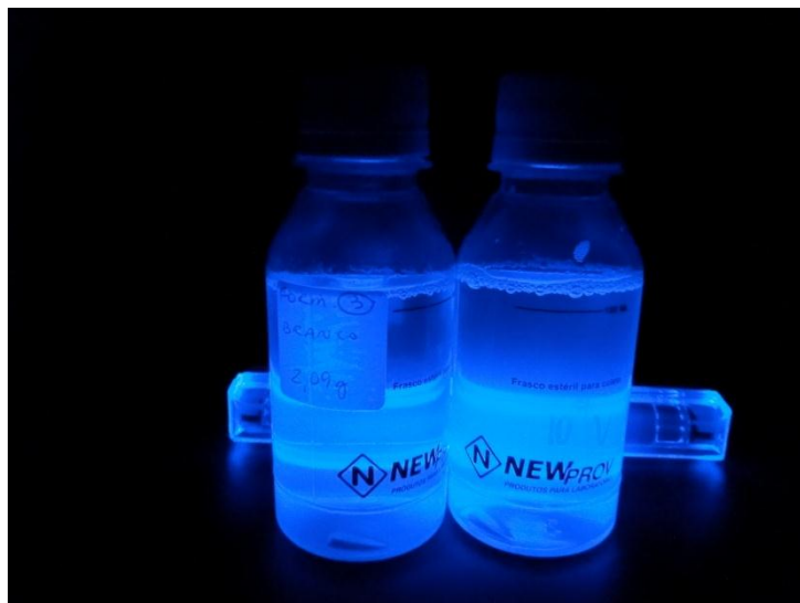
FIGURA 4 - TESTE NEGATIVO E MEIO DE CULTURA C INOCULADO COM S. maltophilia OBSERVADOS SOB LUZ UV 254 NM
