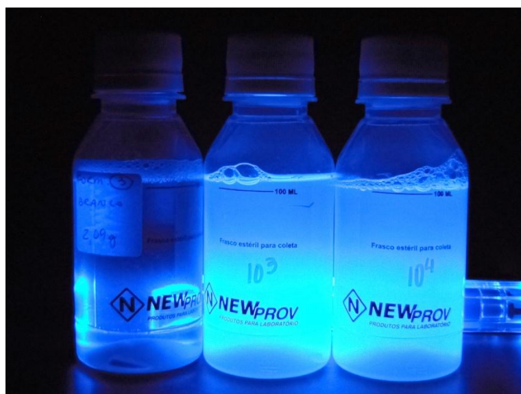
FIGURA 9 - TESTE BRANCO, MEIO DE CULTURA C COM INÓCULO DE 1 \times 10^3 UFC/ML E MEIO DE CULTURA C COM INÓCULO DE 1 \times 10^4 UFC/ML OBSERVADOS SOB LUZ UV DE 254 NM
