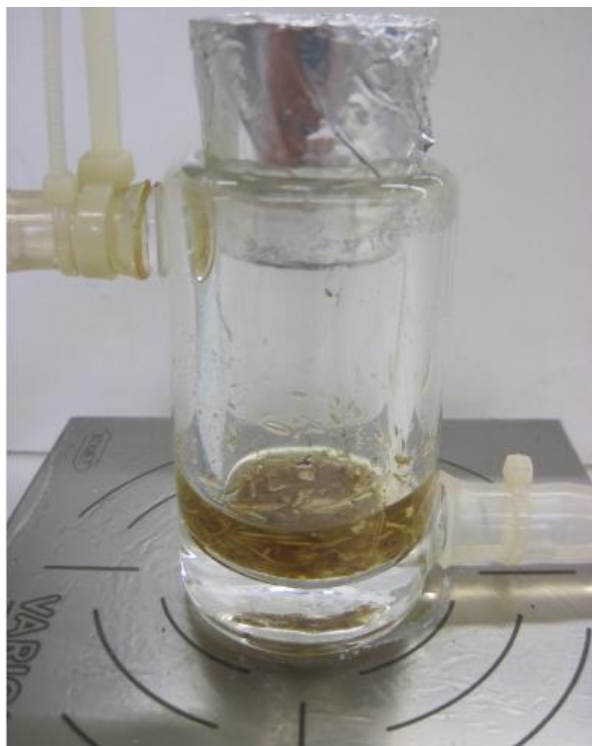
FIGURA 13 - REATOR UTILIZADO EM REAÇ ES DE INTERESTERIFICAÇ O E TRANSESTERIFICAÇ O  CIDA.
