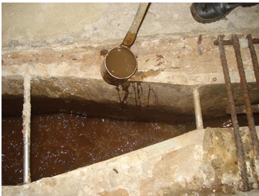
FIGURA 12 - PROCEDIMENTO DE AMOSTRAGEM DA ÁGUA BRANCA EM CALHA PARSHALL COM DISPOSITIVO DE COLETA
