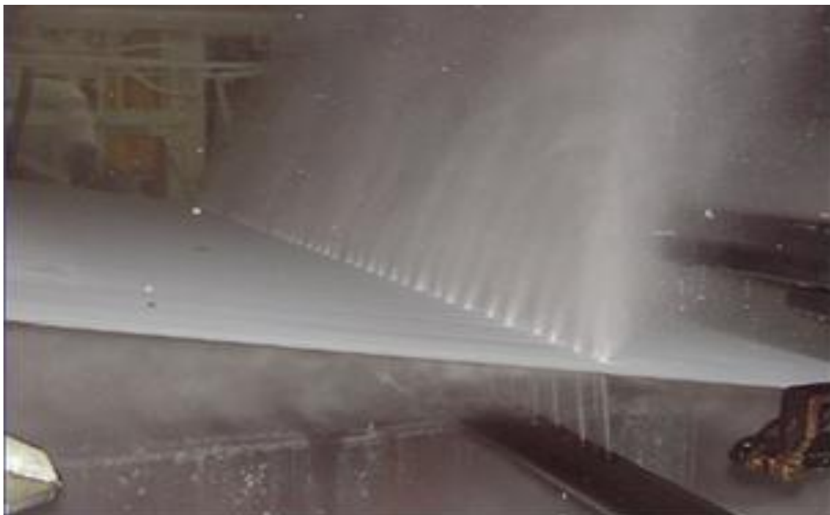
FIGURA 8 - CHUVEIRO DE ALTA PRESSÃO PARA LIMPEZA DA TELA LOCALIZADO NO RETORNO DA TELA FORMADORA
