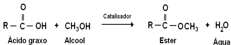
Figura 2.2 – Reação de esterificação de ácidos graxos.
