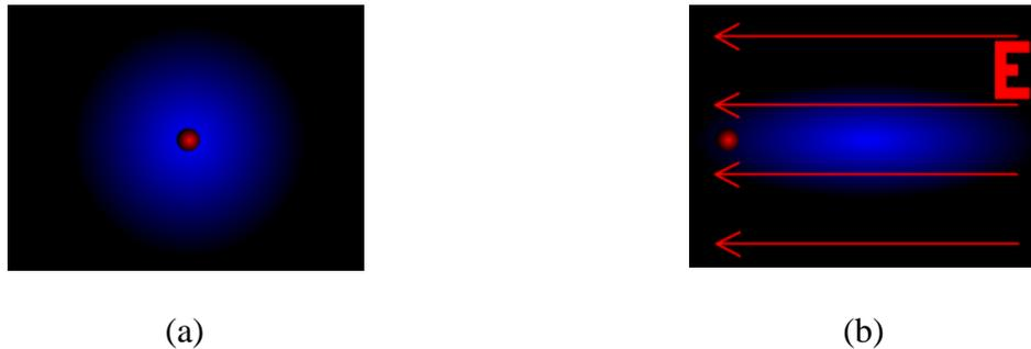
Figura 20 – Ilustração de um átomo, com seu núcleo em vermelho e a nuvem eletrônica em azul, sem a presença de um campo elétrico (a), e com a presença de um campo elétrico (b).
