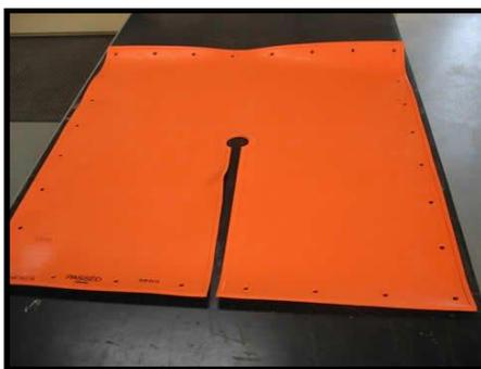
Figura 2 – Lençol isolante de cor laranja, e a manta isolante em baixo, de cor preta.
