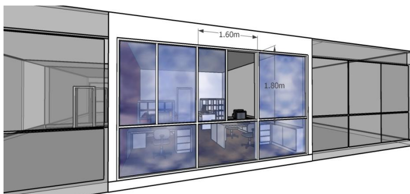
Figura 6.8 - Dimensões e funcionamento da janela da fachada cortina. A janela da sala comercial tem dimensões de 1,60 metros de largura por 1,80 metros de altura, correspondentes a aproximadamente 1/12 da área do piso.
