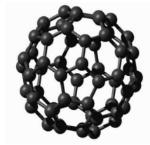
Figura 3.6: Desenho esquemático de uma molécula de fulereno C_{60} . Figura adaptada da Ref. [5]
