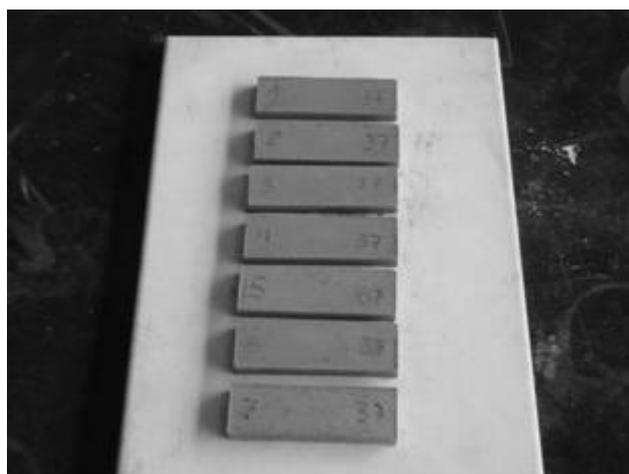
FIGURA 02 – Imagem dos corpos de prova identificados (largura de 20 mm, comprimento 60 mm e espessura de  $5 \text{ mm} \pm 0,10\text{mm}$ )
