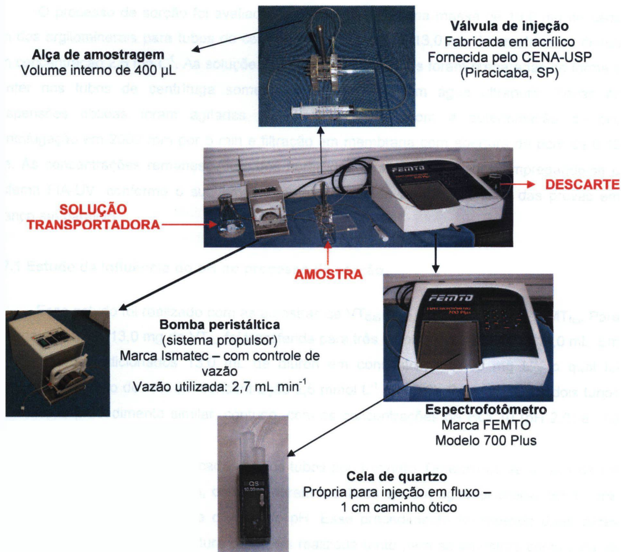
Figura 6 – Sistema FIA-UV utilizado, detalhando cada uma das partes.
