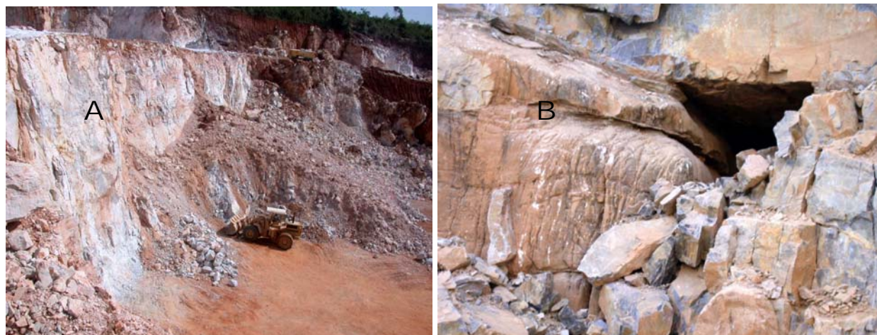
Figura 29- A) Lavra de cal desordenada causando um impacto visual negativo; B) Área em exploração com feições cársticas (gruta) impedindo o prosseguimento da lavra.
