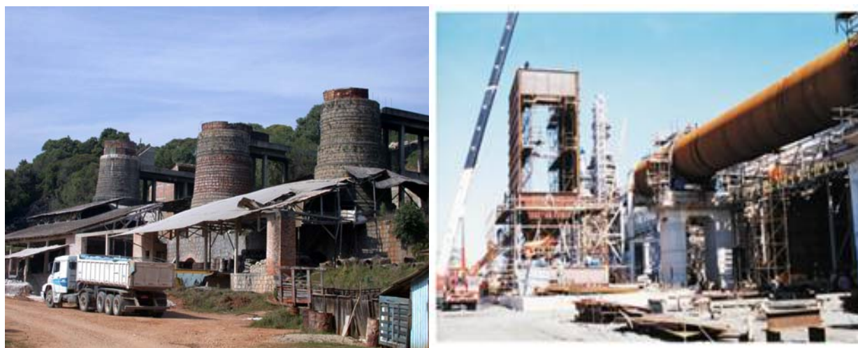
Figura 42 – Na fotografia esquerda temos um beneficiamento da cal na RMC com 3 fornos verticais onde se pode observar um veículo em condições favoráveis contrastando com as instalações ainda precárias. Já na foto da direita ressaltase um forno horizontal de cal representando uma tecnologia de ponta utilizada no Estado de Minas Gerais.
