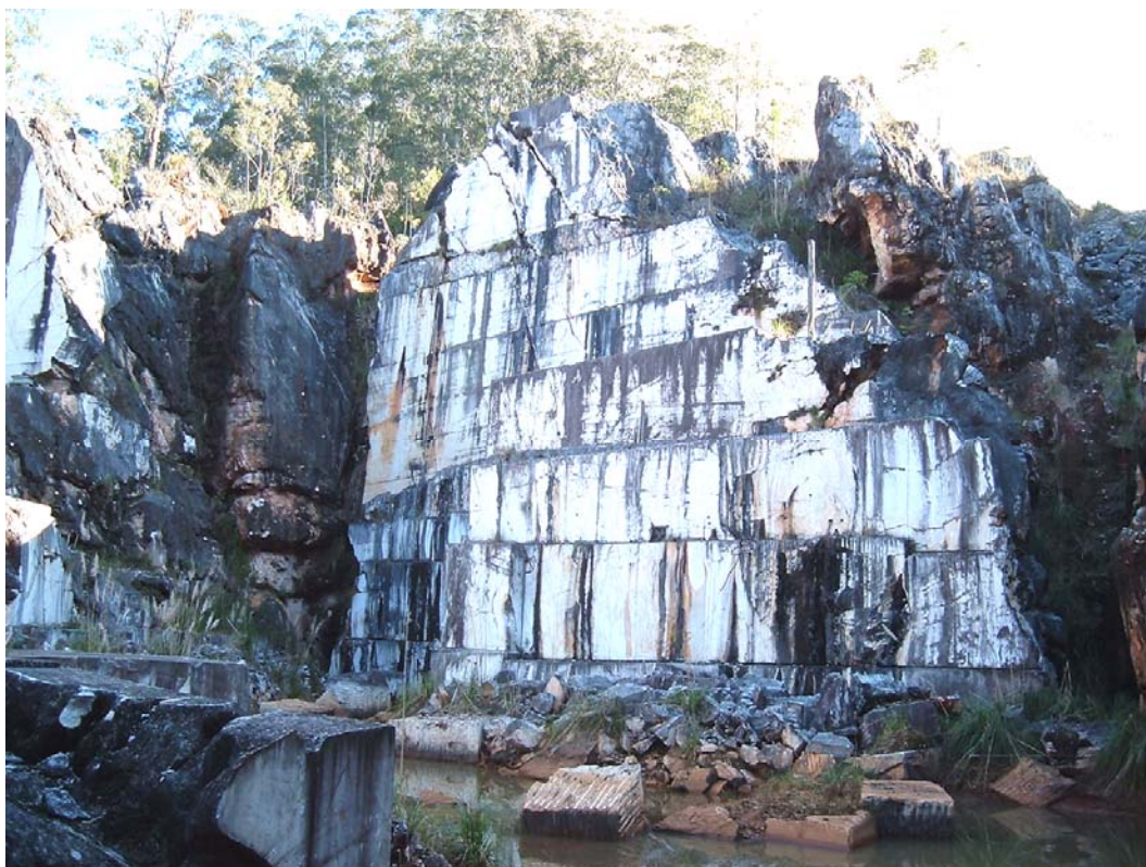
Figura 20 – Mármore maciço, granoblástico, de coloração branca. Vila Capuava – Cerro Azul-PR- Mineradora Bau.
