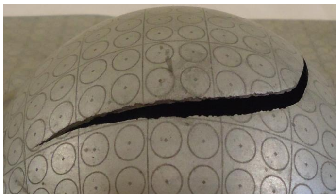
Figura 4.7. Detalhe macroscópico da fratura no CP de 200x200mm estampado com punção hemisférico, para obter o estado de tensão biaxial.
