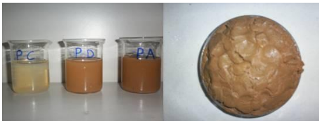
FIGURA 68 - LODOS, ADENSADO E CENTRIFUGADO DA ETA PASSAÚNA FONTE: A AUTORA
