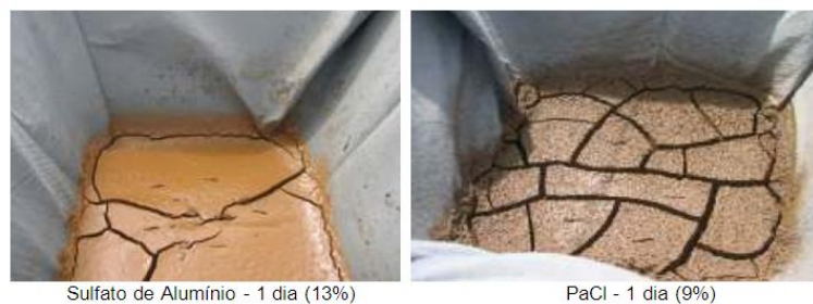
FIGURA 10 - LEITOS DE DRENAGEM APÓS 1 DIA DE APLICAÇÃO DOS LODOS FONTE: ACHON, BARROSO E CORDEIRO (2008)
