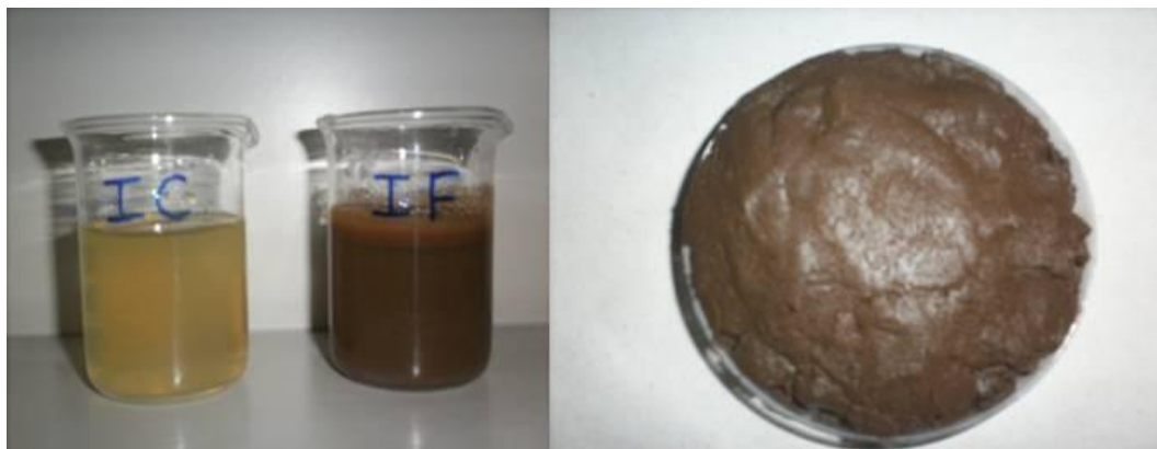
FIGURA 60 - ASPECTO DO LODO CLARIFICADO, FLOTADO E CENTRIFUGADO DA ETA IRAÍ- COLETA DO DIA 10/08 FONTE: A AUTORA
