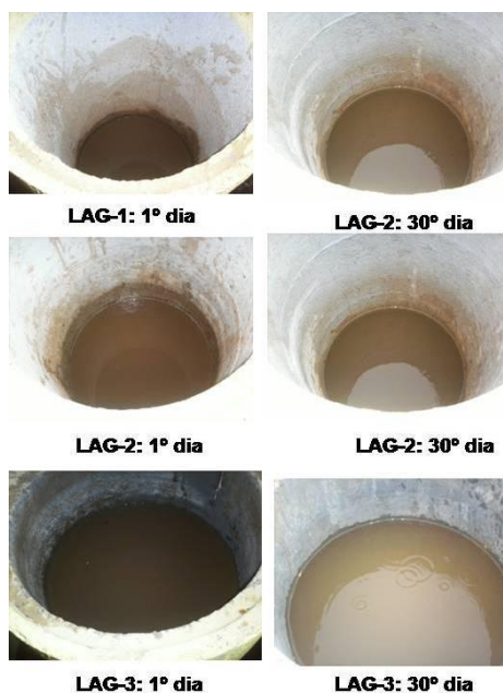
FIGURA A4- ASPECTO DO LODO RETIDO NOS LEITOS LAG – CICLO 1 FONTE: A AUTORA
