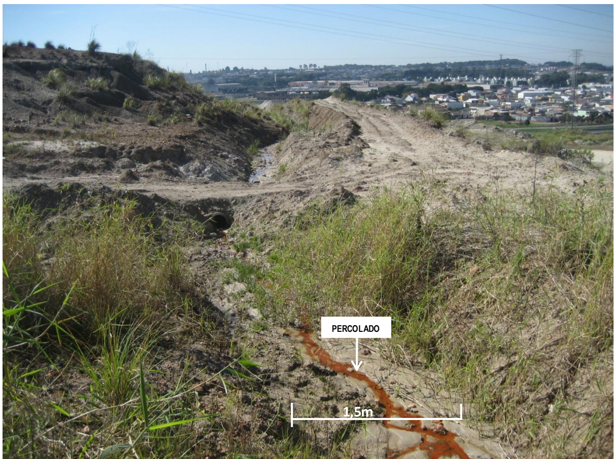
Figura 44: Percolado oriundo do depósito de resíduos que segue pela valeta direcionada ao rio Barigüí (ERBE, 2010).
