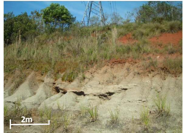
Figura 28: Perfil típico de alteração solo residual vermelho e siltitos da Formação Guabirota (BIOLÓGICA, 2006b).
