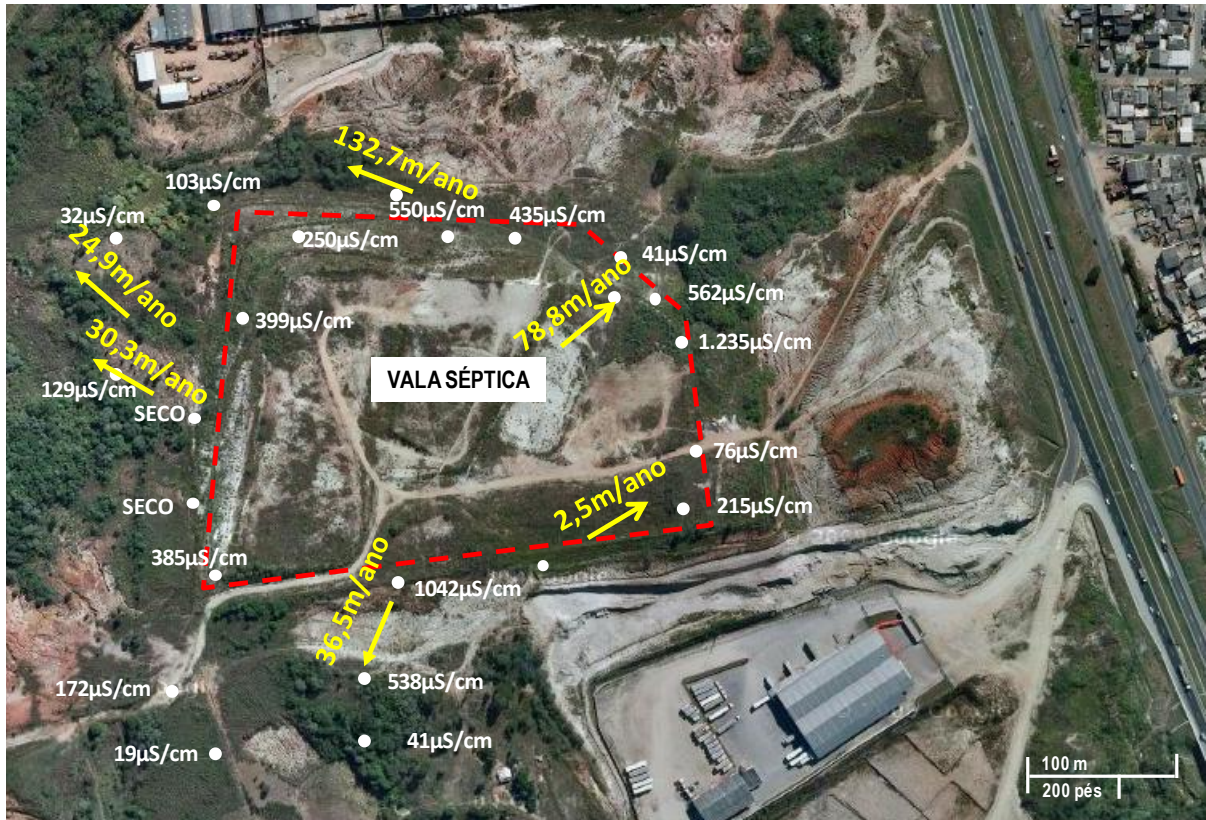
Figura 55: Velocidade de fluxo das águas subterrâneas e indicação da condutividade elétrica nos poços de monitoramento – 2006 (adaptado de BIOLÓGICA, 2006b) (GOOGLE, 2011).
