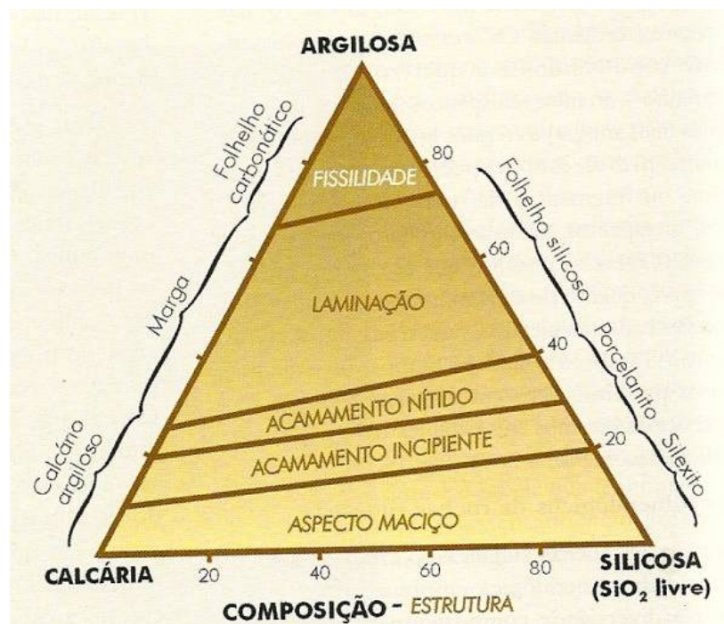
FIGURA 05 - Diagrama triangular mostrando a classificação composicional de rochas sedimentares lutáceas. Nos vértices do triângulo ocorrem os extremos composicionais. As subdivisões internas mostram as estruturas sedimentares predominantes.
