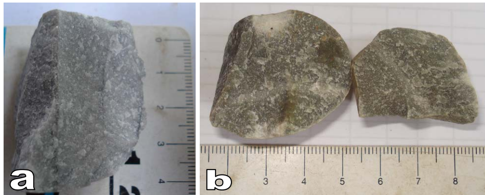
FIGURA 32 a e b - Mármore calcítico de cor cinza clara. Notar aspecto maciço e homogêneo e ausência de veios.
