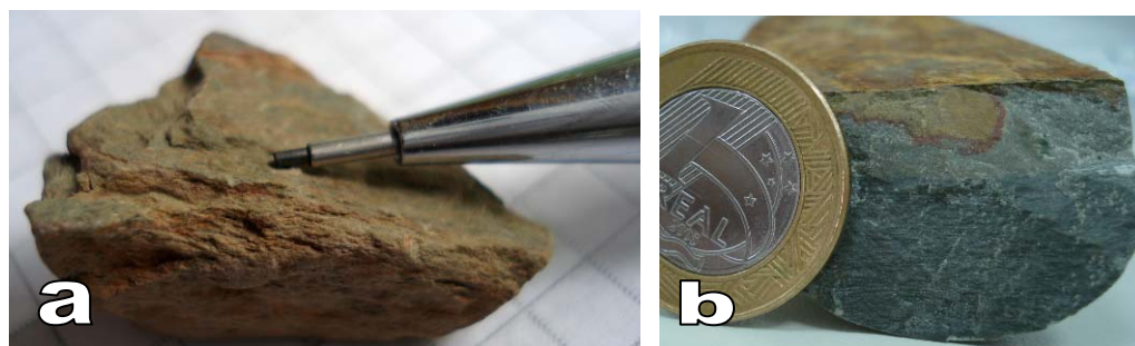
FIGURA 40 - a: Metamarga com foliação incipiente definida pela orientação de filossilicatos. b: Metamarga com bandamento de cores definido pela intercalação de níveis cinza claros com níveis cinza escuros.
