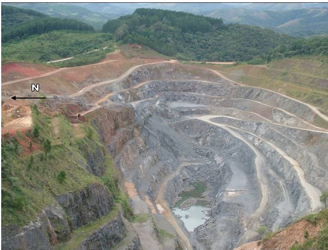
FIGURA 26 - Visão panorâmica da mina rio bonito mostrando suas bancadas. Fotografia obtida em 2007.
