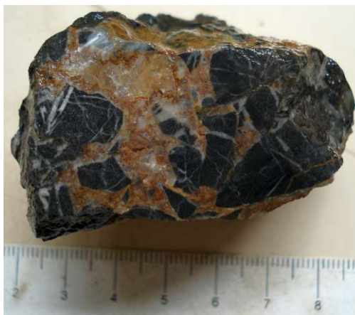
FIGURA 37 - Brecha dolomítica com clastos de mármore dolomítico com dimensões subcentimétricas a centimétricas.
