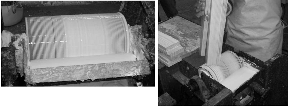
FIGURA 9 - APLICAÇÃO SEMI-MECANIZADA DE ADESIVO PVAc FONTE: O autor (2007)
