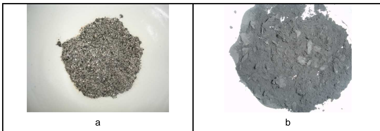
FIGURA 69 - CARVÕES ATIVADOS IMPREGNADOS COM PdCl 2 SEGUNDO O MÉTODO A. a) CAC2 e b) CAPP6.
