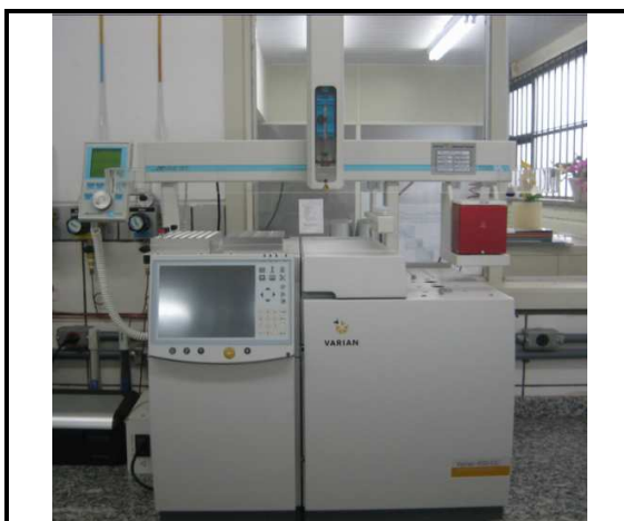
FIGURA 20 - CROMATÓGRAFO GASOSO VARIAN COM DETECTOR PFPD. FONTE: LACAUT/UFPR
