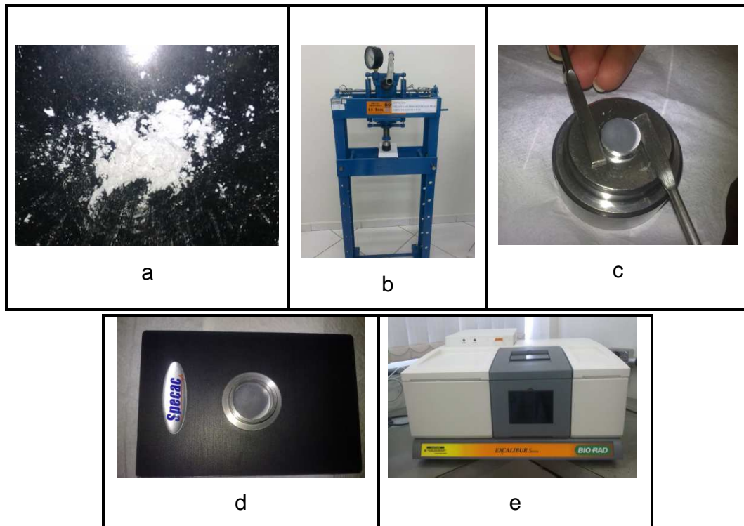
FIGURA 16 - EQUIPAMENTO E UTENSÍLIOS UTILIZADOS NA ANÁLISE DE INFRAVERMELHO. a) KBr e carvão ativado macerados. b) Prensa Hidráulica utilizada na confecção da pastilha. c) Pastilha de carvão ativado e KBr. d) Pastilha no porta amostra. e) Equipamento Bruker Vertex 70. FONTE: Laboratório do Departamento de Química/UFPR.
