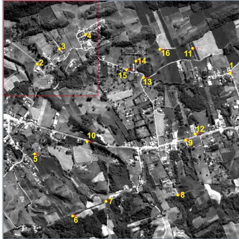
FIGURA 18 – POSICIONAMENTO DOS PONTOS DE CONTROLE FONTE: O AUTOR (2009).
