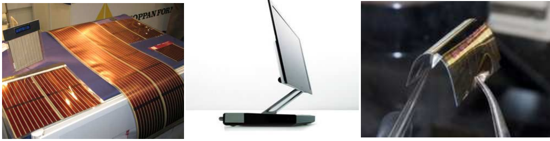
Figura 7 - Exemplos de aplicações dos polímeros semicondutores. Painéis solares (esquerda), OLED (centro) e transistores flexíveis (direita).
