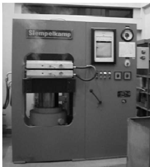
FIGURA 27 - PRENSA HIDRÁULICA COM CONTROLE DE TEMPERATURA E PRESSÃO UTILIZADA PARA PRODUÇÃO DOS PAINÉIS.
