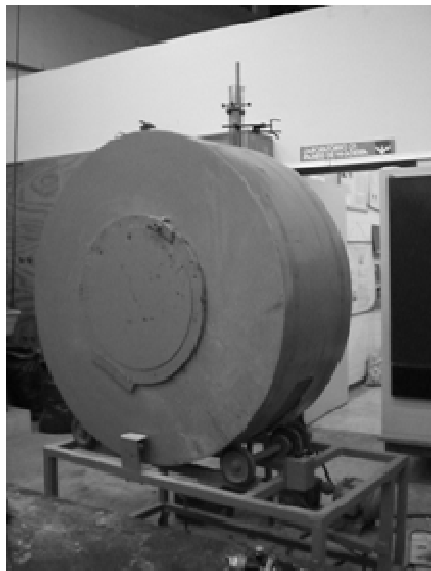
FIGURA 24 - ENCOLADEIRA DE PARTÍCULAS UTILIZADA PARA APLICAÇÃO DA PARAFINA E RESINA COM CATALISADOR NAS FIBRAS DE PINUS.
