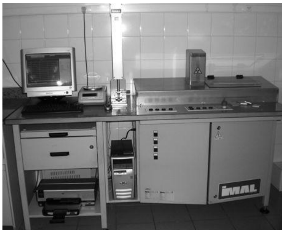
FIGURA 30 - EQUIPAMENTO UTILIZADO PARA DETERMINAÇÃO DO PERFIL DE DENSIDADE MARCA IMAL, MODELO DPX 200 CEDIDO PELA EMPRESA FIBRAPLAC CHAPAS DE MDF LTDA
