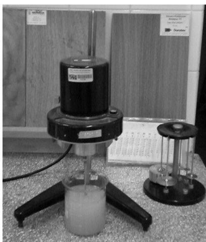
FIGURA 17 – VISCOSÍMETRO ANALÓGICO TIPO BROOKFIELD UTILIZADO PARA DETERMINAÇÃO DA VISCOSIDADE EM mPa.s DAS RESINAS.
