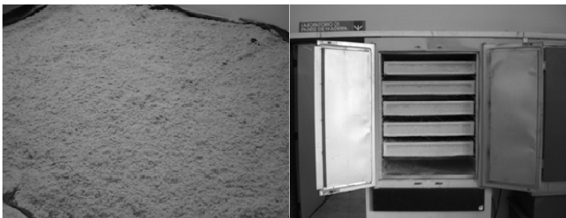
FIGURA 21 - (a) PRÉ-SECAGEM DAS FIBRAS; (b) SECAGEM ARTIFICIAL EM ESTUFA MICRO PROCESSADA COM CIRCULAÇÃO FORÇADA DE AR
