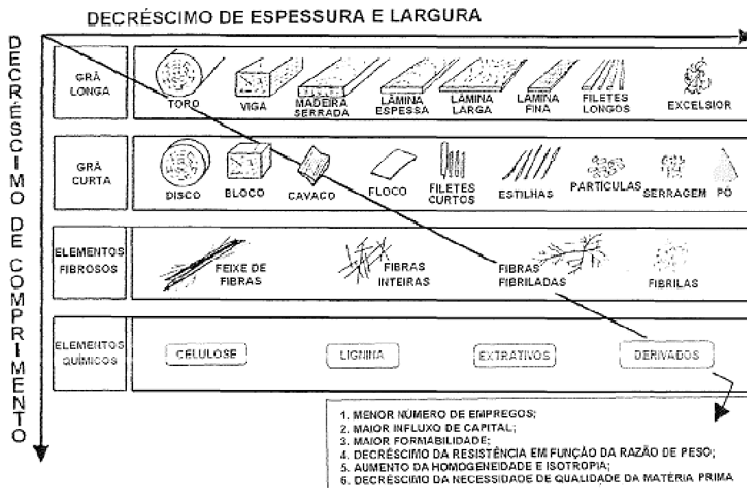
FIGURA 7 - ELEMENTOS BÁSICOS OBTIDOS DA MADEIRA, PEÇAS BRUTAS DE MAIORES DIMENSÕES ATÉ SUA ESTRUTURA BÁSICA DE COMPOSIÇÃO.
