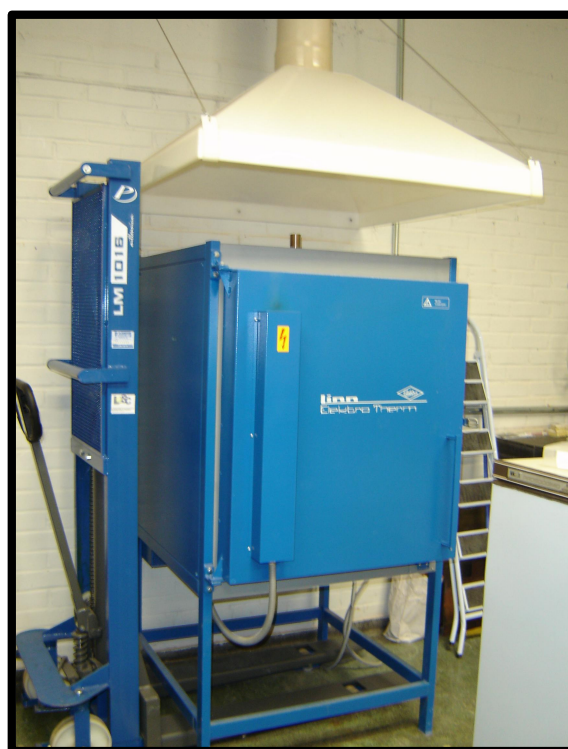
Figura 25 - Vista do forno, coifa e carregador de Pallets.
