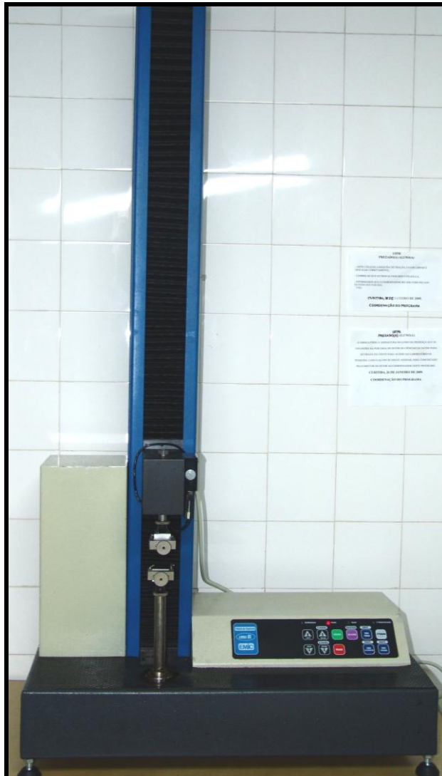
FIGURA 7 – Máquina universal de ensaio mecânico computadorizada modelo DL-500 MF Fonte: O autor
