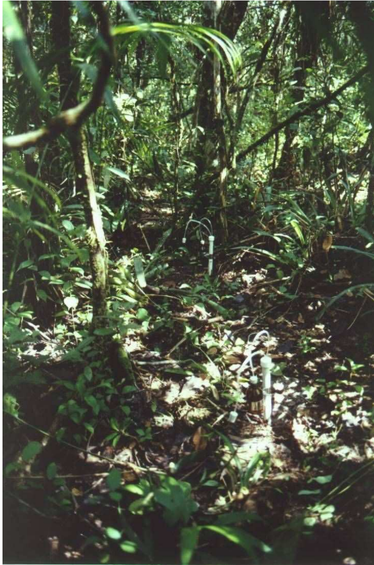
FIGURA 5: Lisímetros instalados no solo em fase Intermediária da sucessão florestal.
