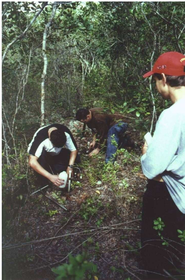
FIGURA 2: Instalação dos lisímetros no solo em fase Inicial da sucessão florestal.
