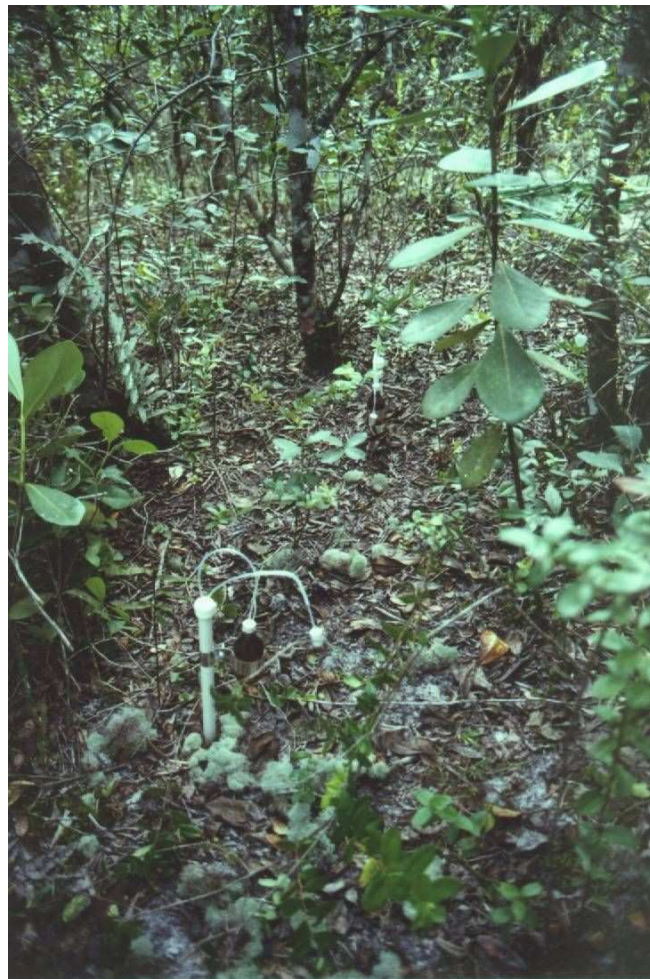
FIGURA 4: Lisímetros instalados no solo em fase Inicial da sucessão florestal.
