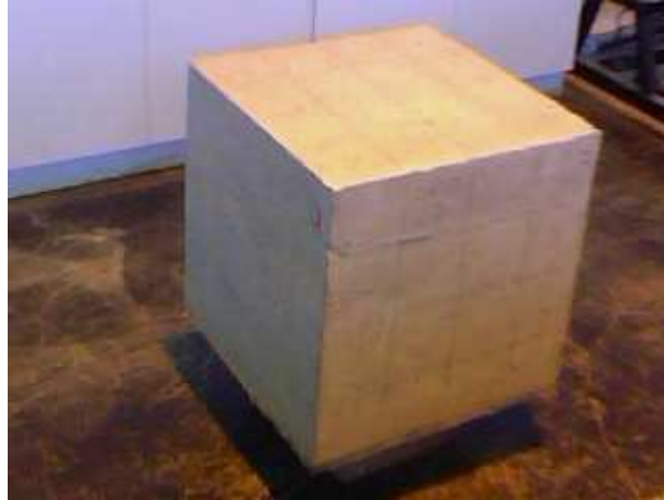
Figura 52 – Bloco de concreto com defeito para ensaios em laboratório.
