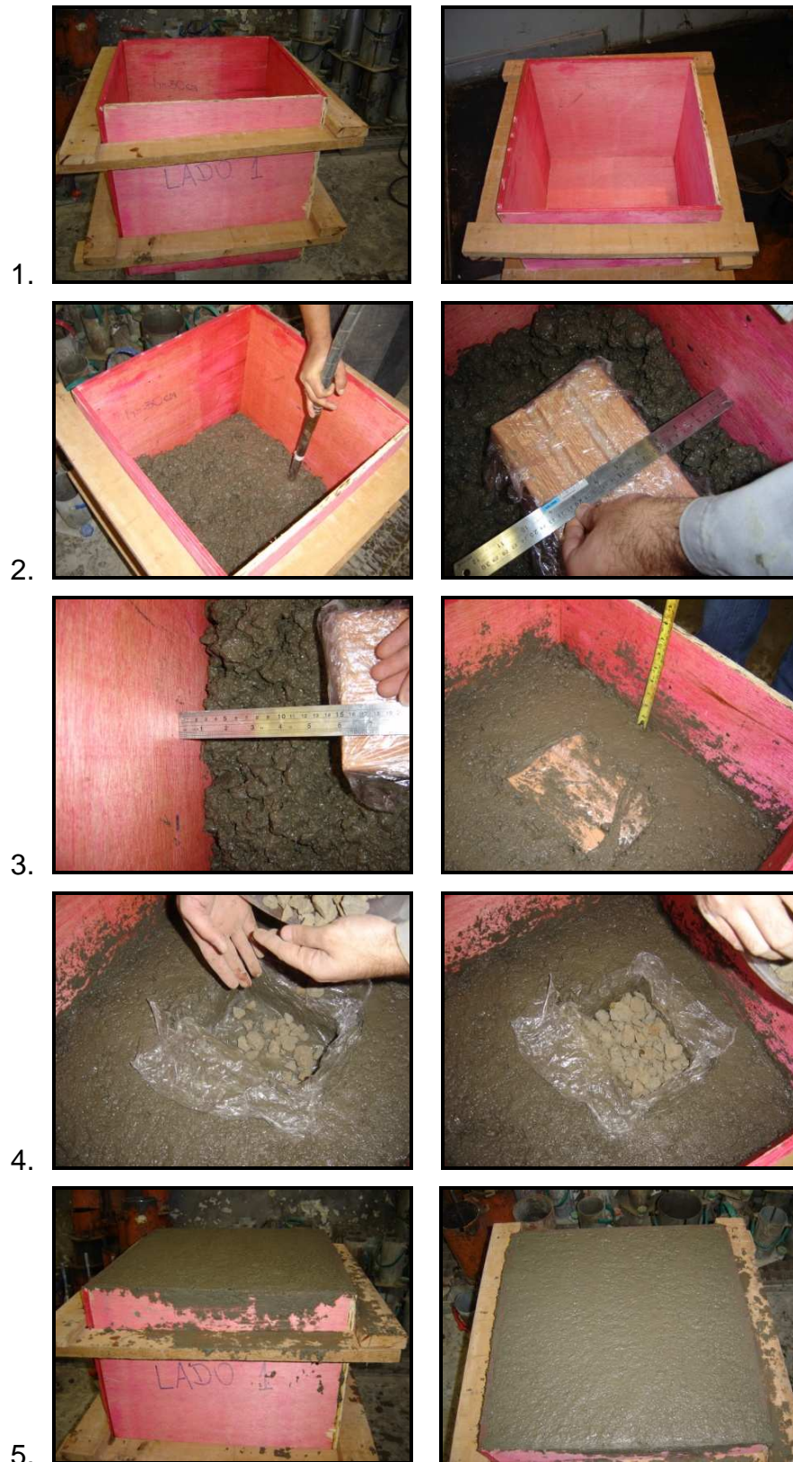
Figura 51 – Concretagem do bloco com defeito para ensaios em laboratório.
