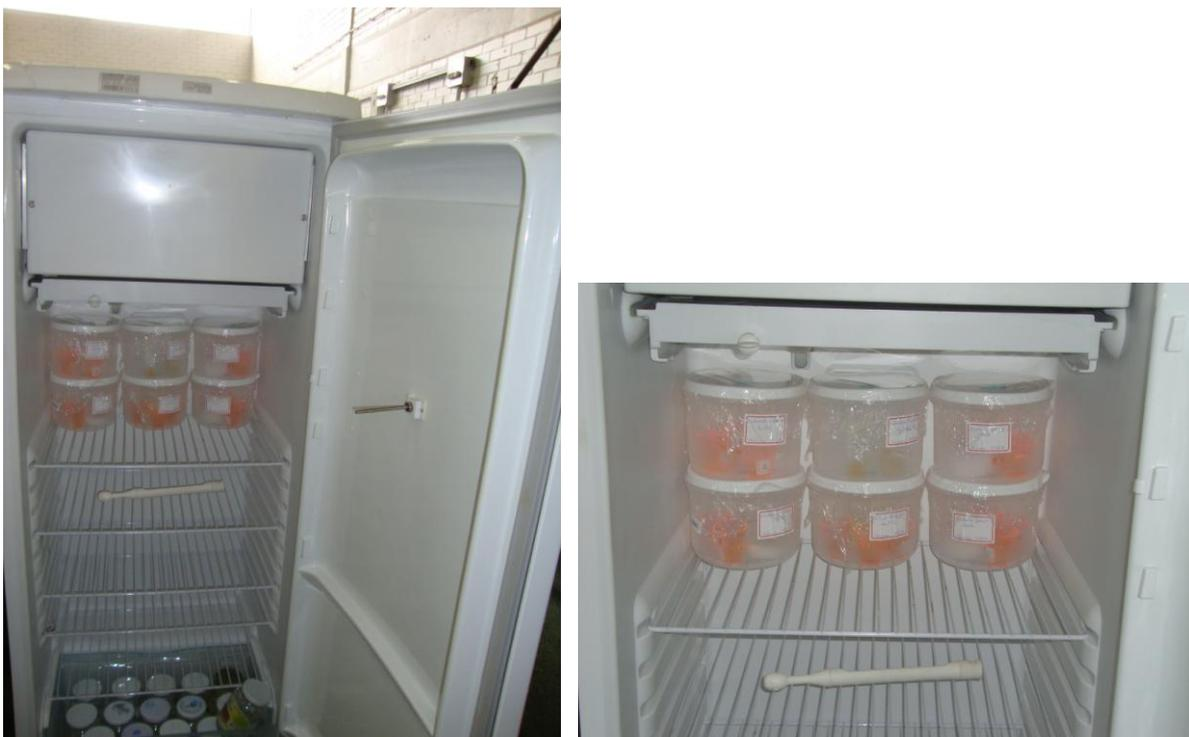
FIGURA 11 – ESTUFA B.O.D. UTILIZADA PARA ELABORAÇÃO DAS ISOTERMAS DE SORÇÃO
